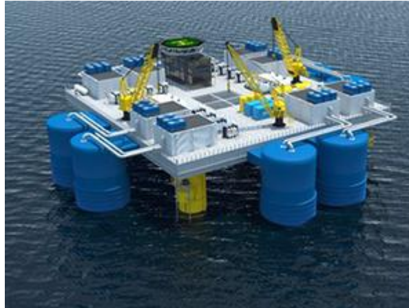
Σχήμα 6.10 Μακέτα Μονάδας Αξιοποίησης OTEC
