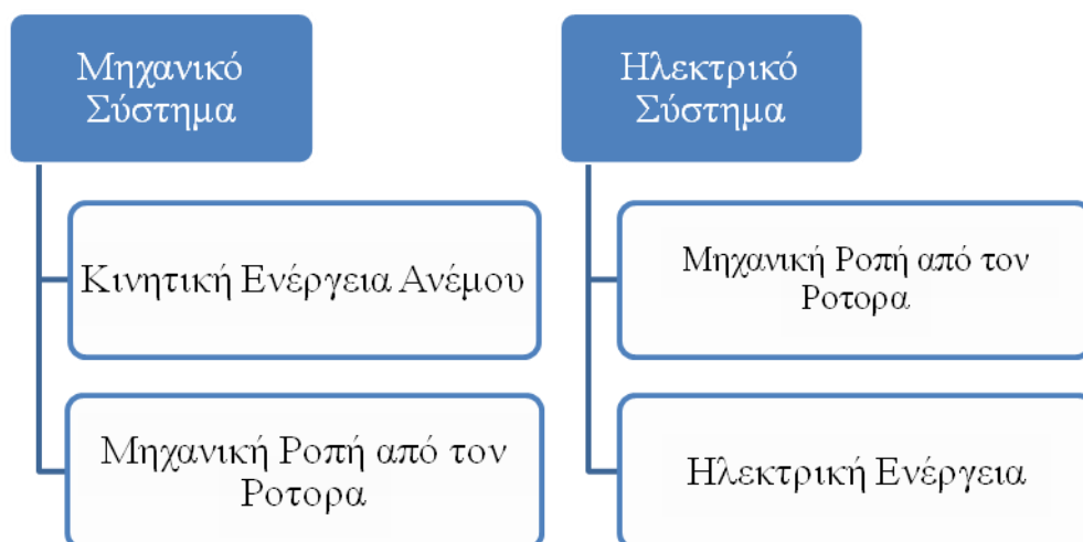
Εικόνα 9 Απλοποιημένο μηχανικό και ηλεκτρικό σύστημα της ανεμογεννήτριας
