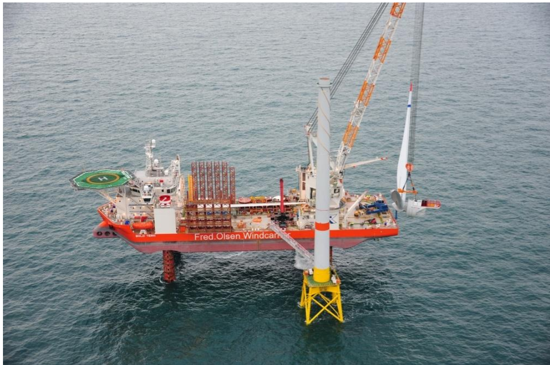
Εικόνα 19 Κατά τη διαδικασία τοποθέτησης των ανεμογεννητριών 40
