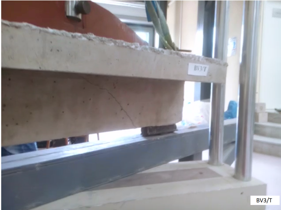
Σχήμα 2.30 Αστοχία πλακοδοκού BV3/T
