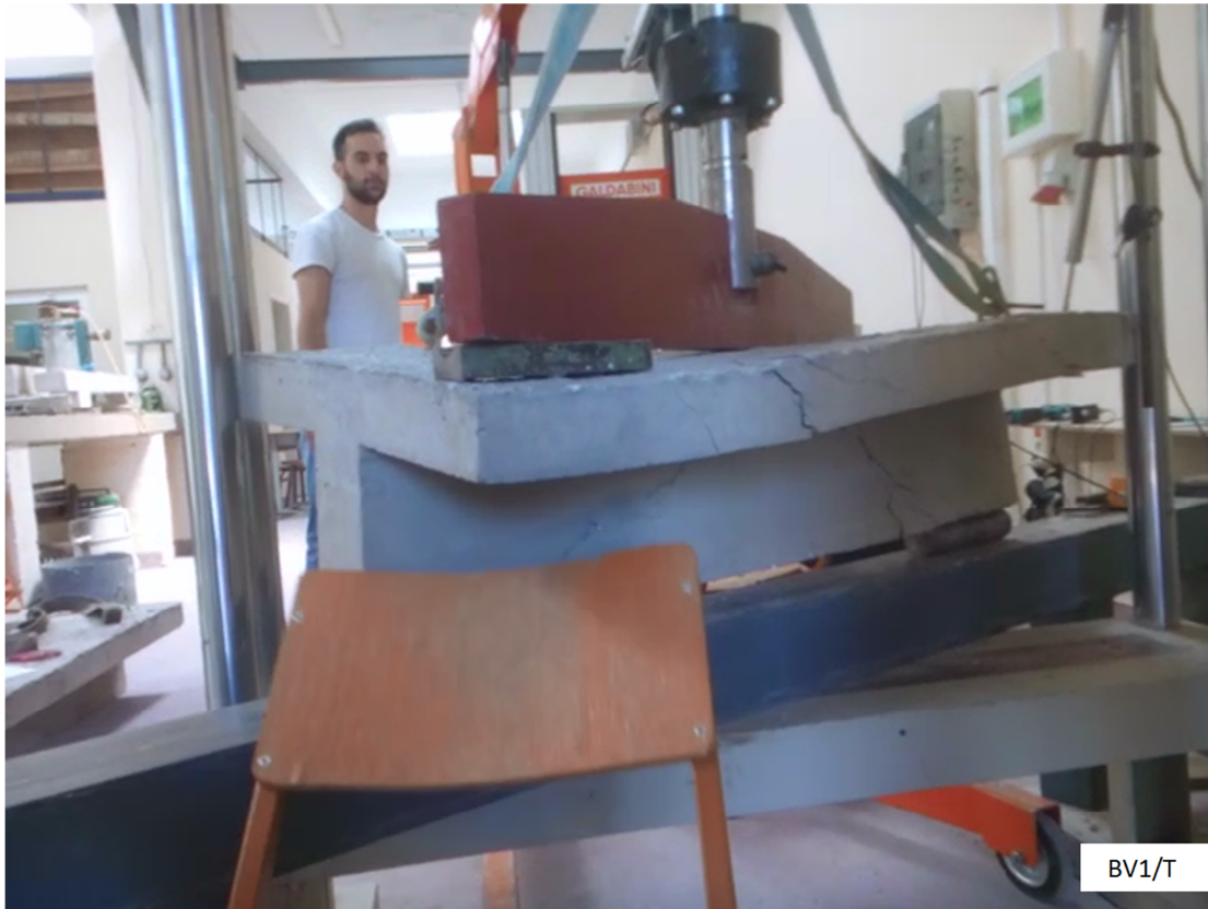
Σχήμα 2.28 Αστοχία πλακοδοκού BV1/T
