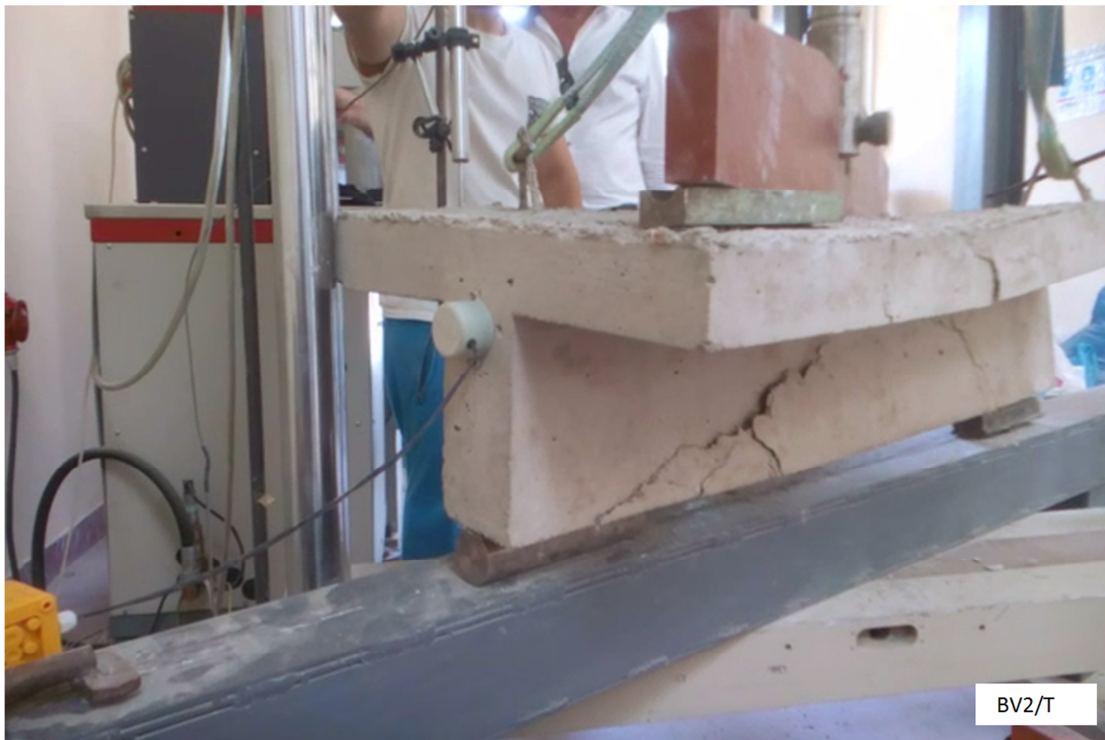
Σχήμα 2.29 Αστοχία πλακοδοκού BV2/T
