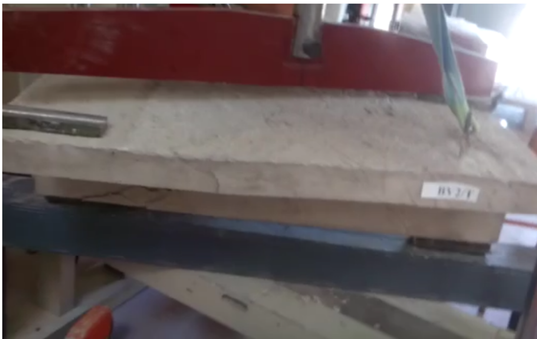
Σχήμα 2.23 Πλακοδοκός μετά τη δοκιμή σε στρέψη
