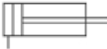
Σχ. 2: Κύλινδρος απλής ενέργειας χωρίς ελατήριο επαναφοράς
