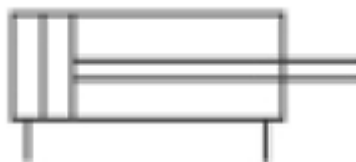
Σχ. 4: Συμβολισμός κυλίνδρου με απλό βάκτρο
