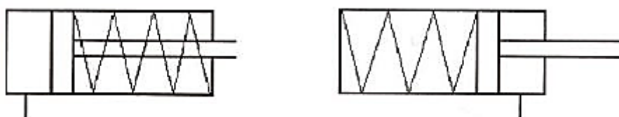
Σχ. 3: Κύλινδρος απλής ενέργειας με ελατήριο επαναφοράς
