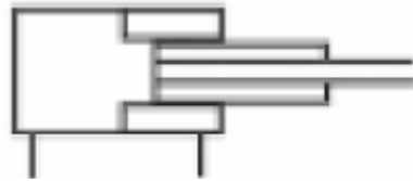
Σχ. 6: Συμβολισμός τηλεσκοπικού κυλίνδρου
