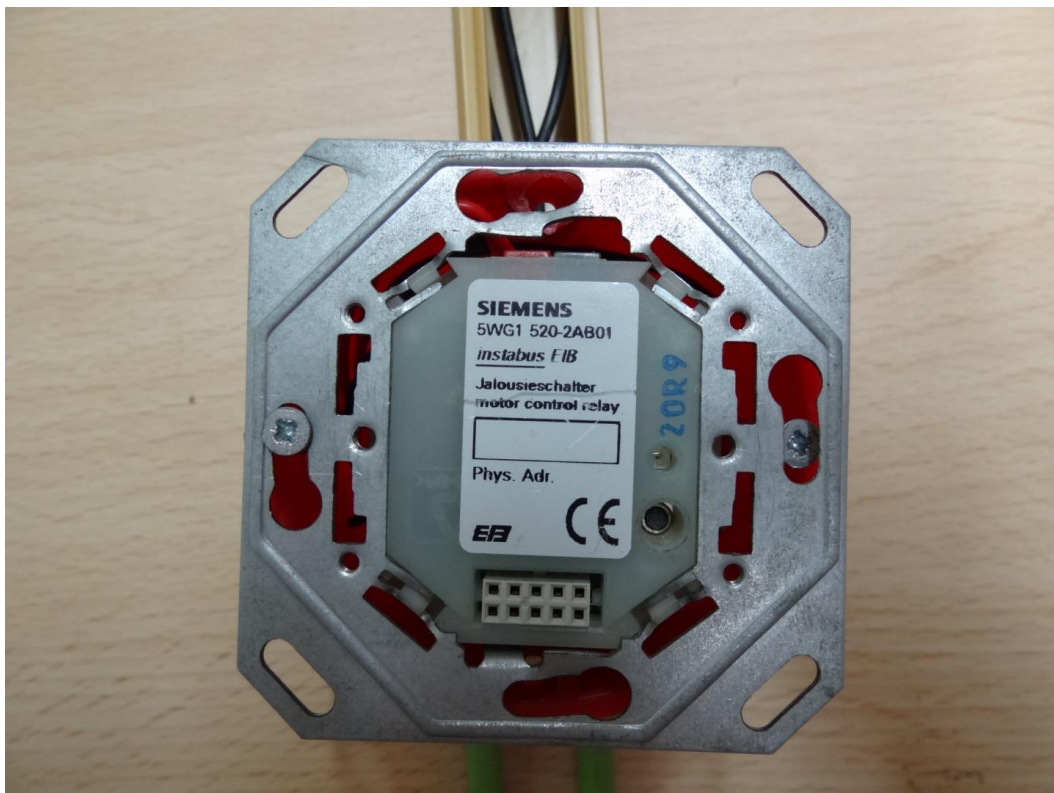
Εικόνα 2.6 Διακόπτης για ηλεκτρολογικά ρολά
