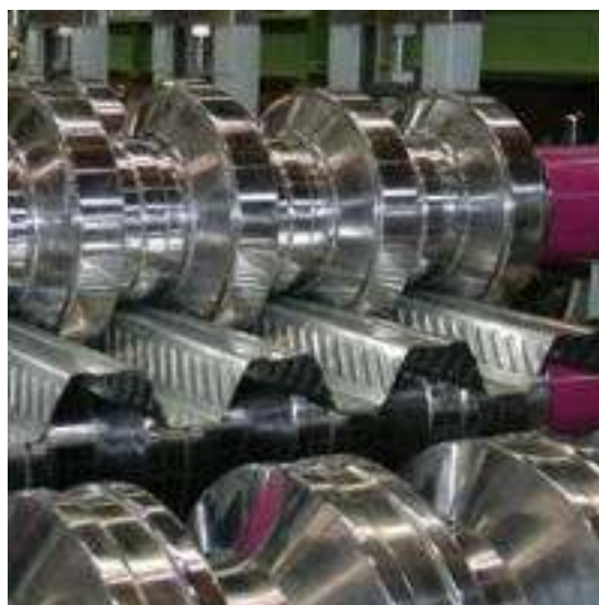
Εικόνα 14 Διαμόρφωση χαλυβδόφυλλων για σύμμικτες πλάκες
