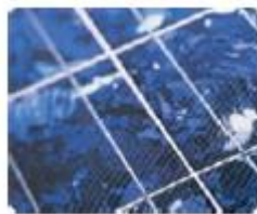
Σχήμα 3.4: Φωτοβολταϊκό στοιχείο πολυκρυσταλλικού πυριτίου
