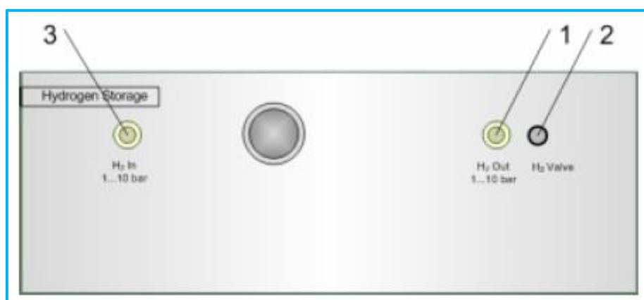
Σχήμα 16: Πρόσθια πλευρά μονάδας αποθήκευσης υδρογόνου
