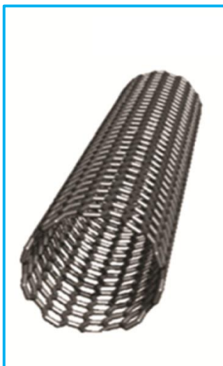
Σχήμα 4: (α) Μονοφλοιϊκός σωλήνας
