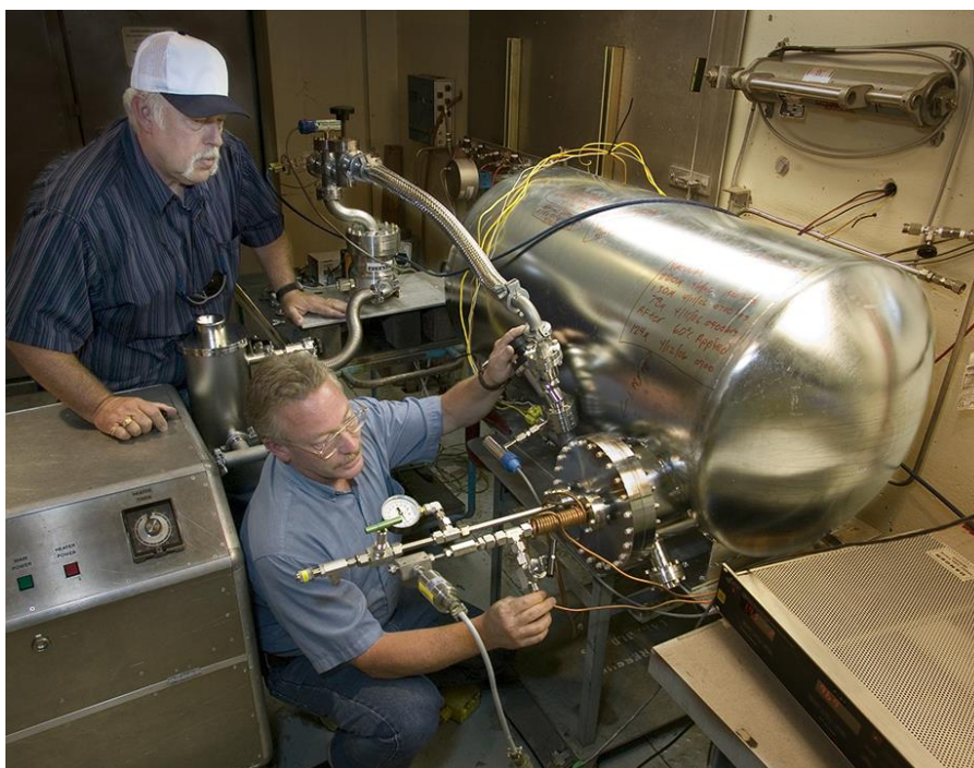
Σχήμα 1: Κρυογονική δεξαμενή αποθήκευσης υδρογόνου
