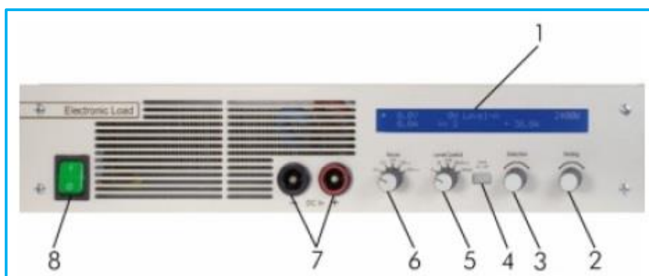
Σχήμα 12: Μονάδα προσομοίωσης DC φορτίου
