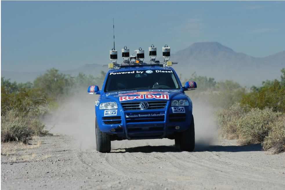
Εικόνα 39 - Αυτόνομο Ρομπωτικό Όχημα από το Πανεπιστήμιο του Στανφορντ
