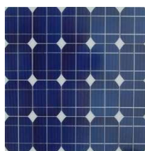
2.2.1.1 Στοιχείο μονοκρυσταλλικού πυριτίου
