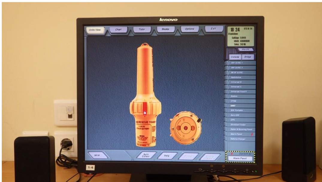
Εικόνα 1.1: Προσομοιωτής GMDSS Σχολής Πλοιάρχων Ακαδημίας Εμπορικού Ναυτικού Ασπροπύργου, συσκευή αναμεταδότη SART (UHF – 9GHz) (Πηγή: Προσωπικό αρχείο)
