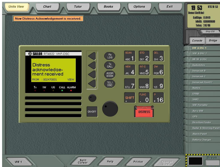
Εικόνα 3.2.2.11: Σενάριο κλήσης κινδύνου μέσω VHF (Λήψη κλήσης κινδύνου από άλλο σταθμό) (Πηγή: Προσωπικό αρχείο)
