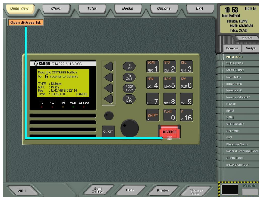
Εικόνα 3.2.2.8: Σενάριο κλήσης κινδύνου μέσω VHF (Πάτημα Distress για 5 sec) (Πηγή: Προσωπικό αρχείο)
