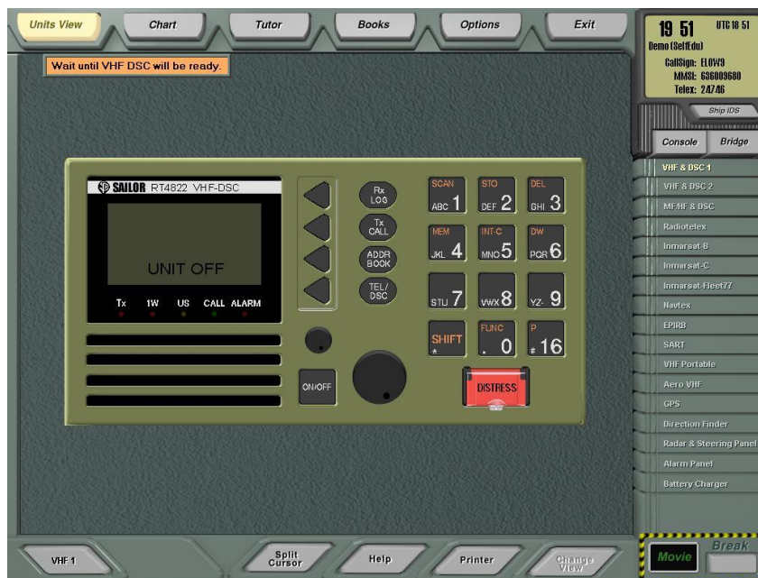
Εικόνα 3.2.2.1: Σενάριο κλήσης κινδύνου μέσω VHF (πάτημα ON/OFF)
