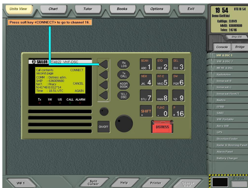
Εικόνα 3.2.2.12: Σενάριο κλήσης κινδύνου μέσω VHF (Πάτημα CONNECT για μετάβαση στο κανάλι 16) (Πηγή: Προσωπικό αρχείο)
