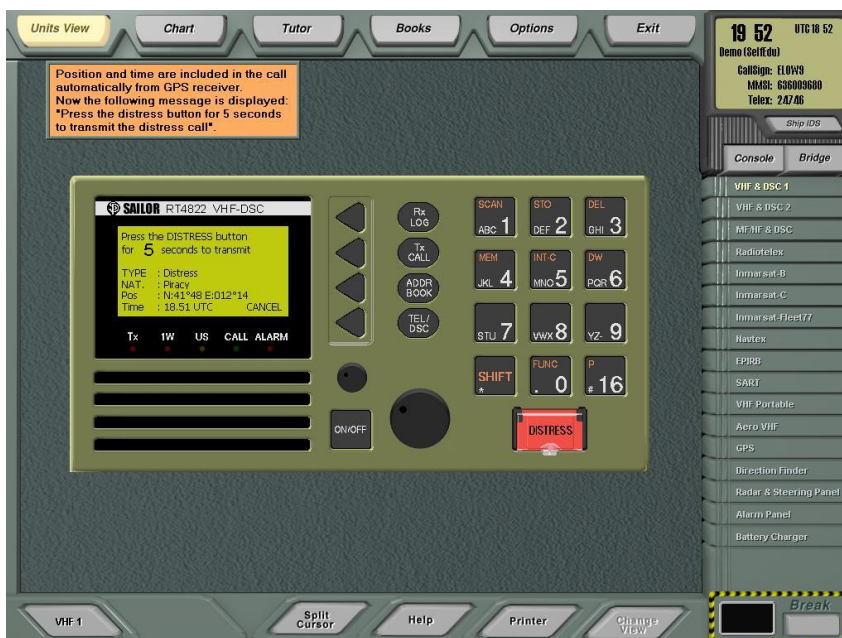
Εικόνα 3.2.2.6: Σενάριο κλήσης κινδύνου μέσω VHF (Θέση πλοίου και ώρα) (Πηγή: Προσωπικό αρχείο)
