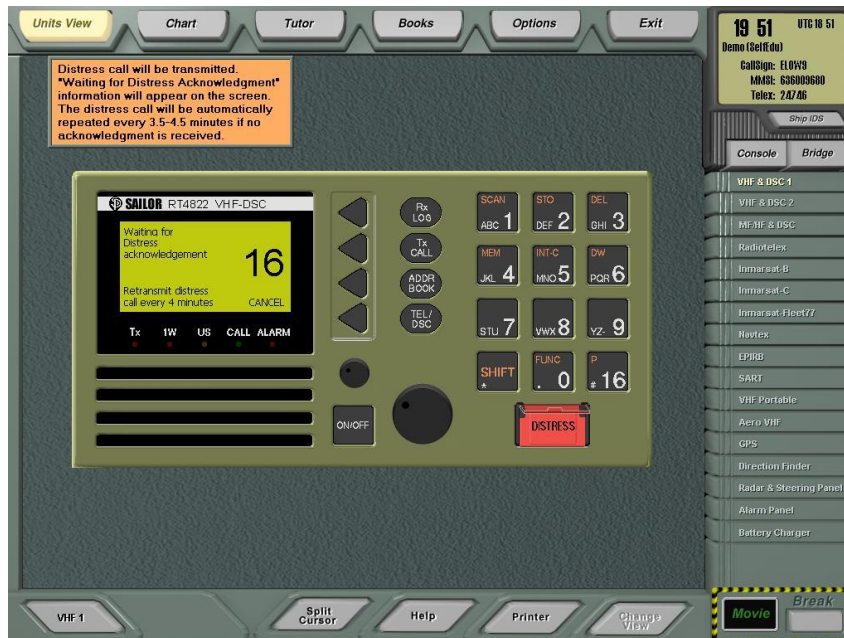
Εικόνα 3.2.2.10: Σενάριο κλήσης κινδύνου μέσω VHF (Αναμονή βεβαίωσης λήψης κινδύνου από άλλο σταθμό) (Πηγή: Προσωπικό αρχείο)
