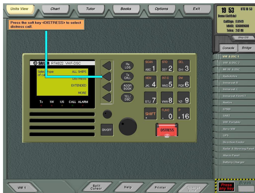
Εικόνα 3.2.2.4: Σενάριο κλήσης κινδύνου μέσω VHF (Πάτημα Distress) (Πηγή: Προσωπικό αρχείο)
