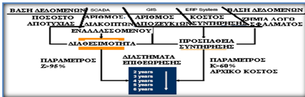
Εικόνα 4.5.1 Στρατηγική επιβλεπόμενης ανίχνευσης παρακμής του εξοπλισμού
