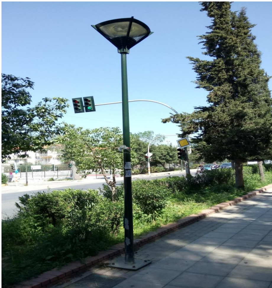
Εικόνα 4.21 Φωτιστικό σώμα, διακοσμητικό σε πιο μοντέρνα αρχιτεκτονική γραμμή, στα 3 μέτρα, τύπου non cutoff. Φέρει μία φωτεινή πηγή τύπου HQI 70W. Χρησιμοποιείται από το Δήμο για τον φωτισμό πεζοδρομίου με διακόσμηση
