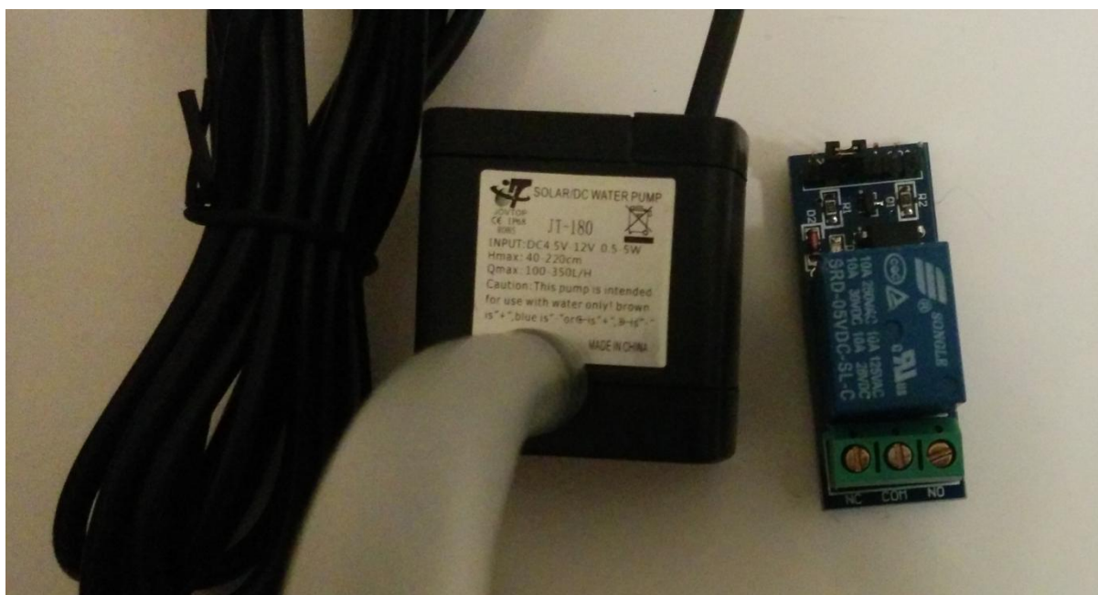
Εικόνα 28 - Αντλία νερού και relay για έλεγχο της μέσω του Arduino
