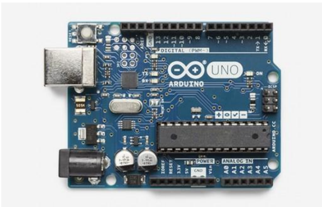
Εικόνα 16 – Το Arduino Uno με τον μικροελεγκτή ATmega328P [15]
