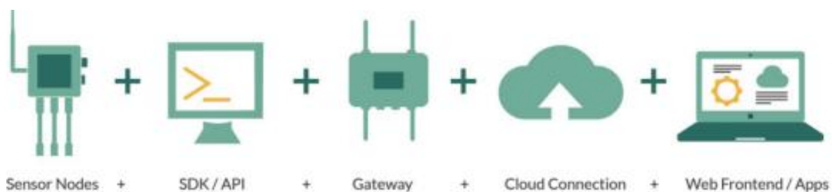
Εικόνα 13 – Η αλυσίδα συλλογής δεδομένων από αισθητήρες και εμφάνιση αυτών στον χρήστη [12]
