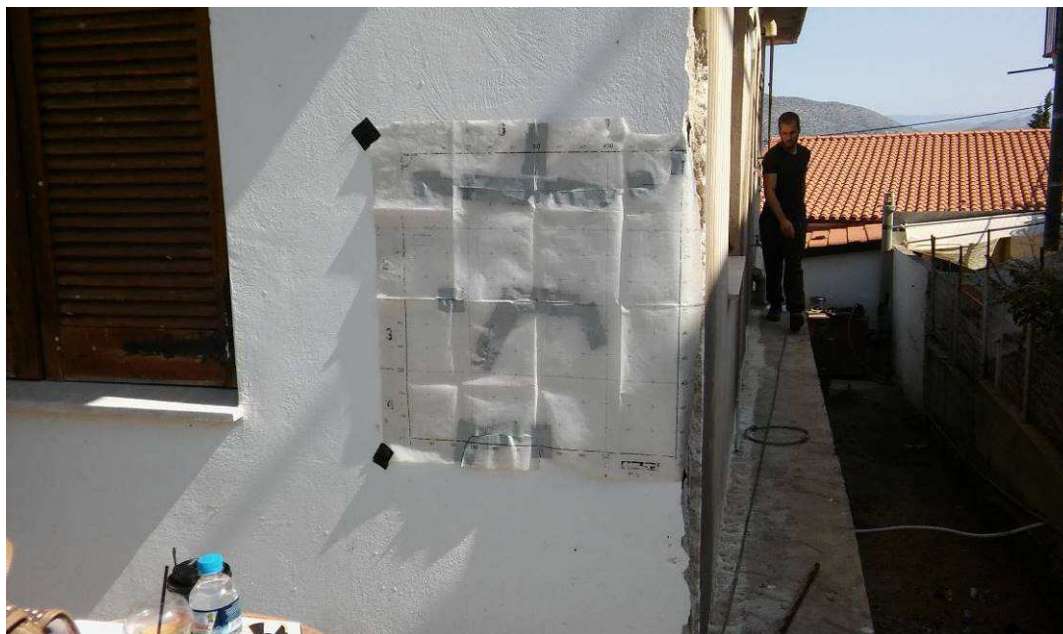
Εικόνα 33. Μεμβράνη αποτύπωσης οπλισμού στο Κ3
