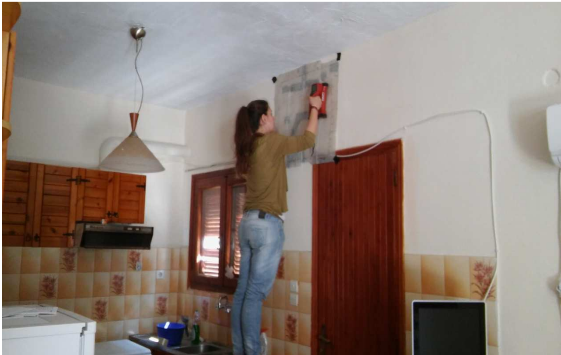
Εικόνα 43. Μεμβράνη αποτύπωσης οπλισμού στο Δ2
