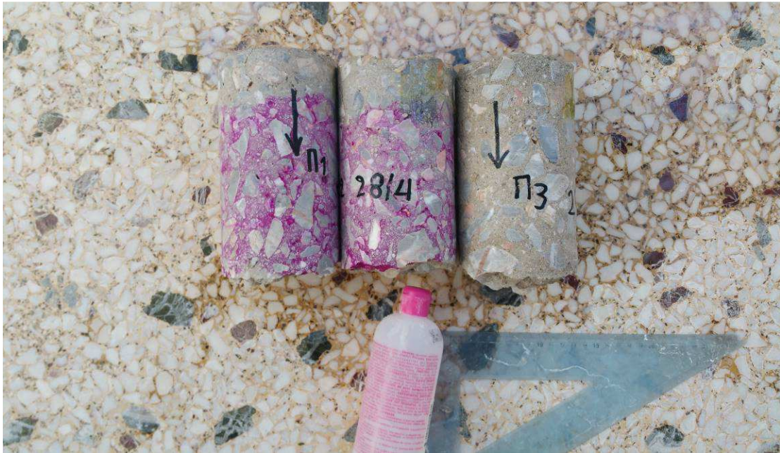
Εικόνα 29. Έλεγχος βάθους ενανθράκωσης
