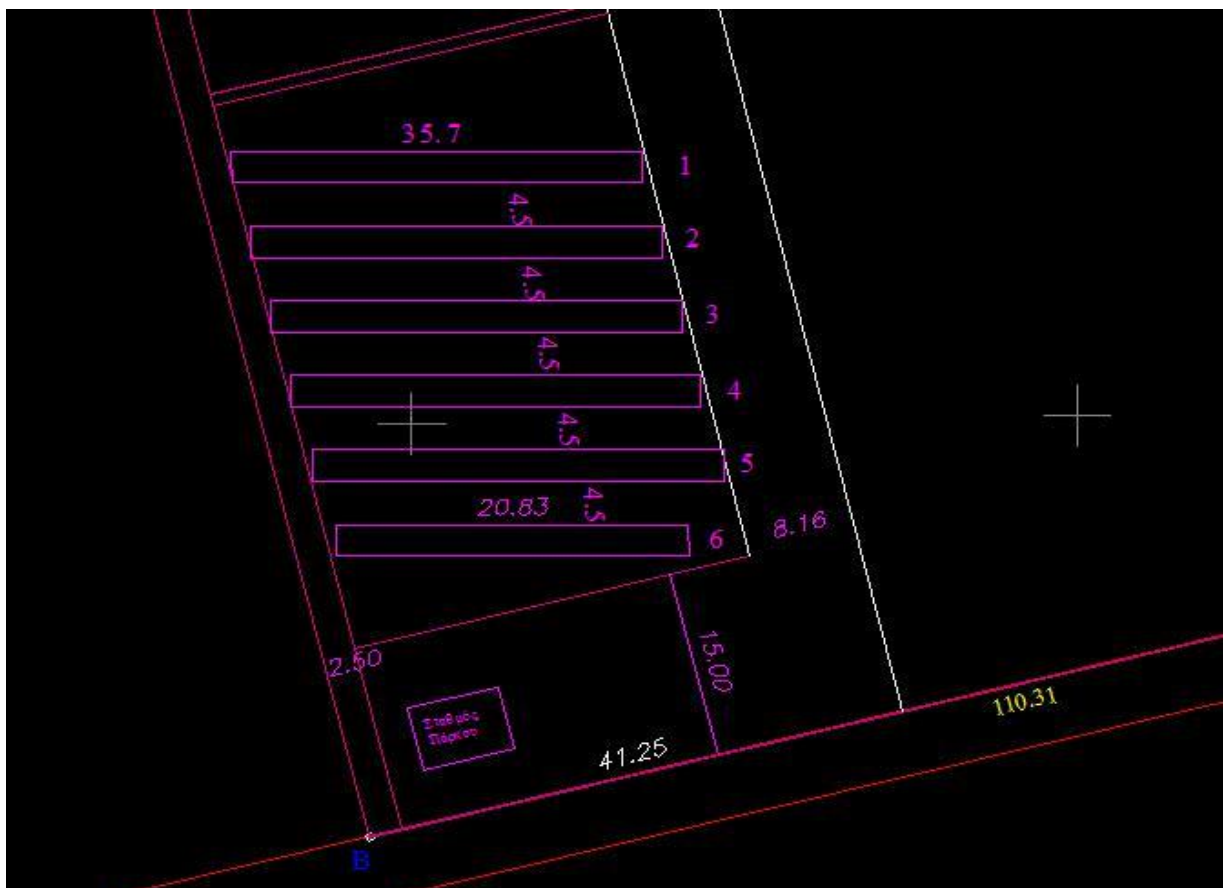
Σχήμα 4.1: Απόσταση στοιχειοσειρών αποφυγή σκίασης μεταξύ των πλαισίων
