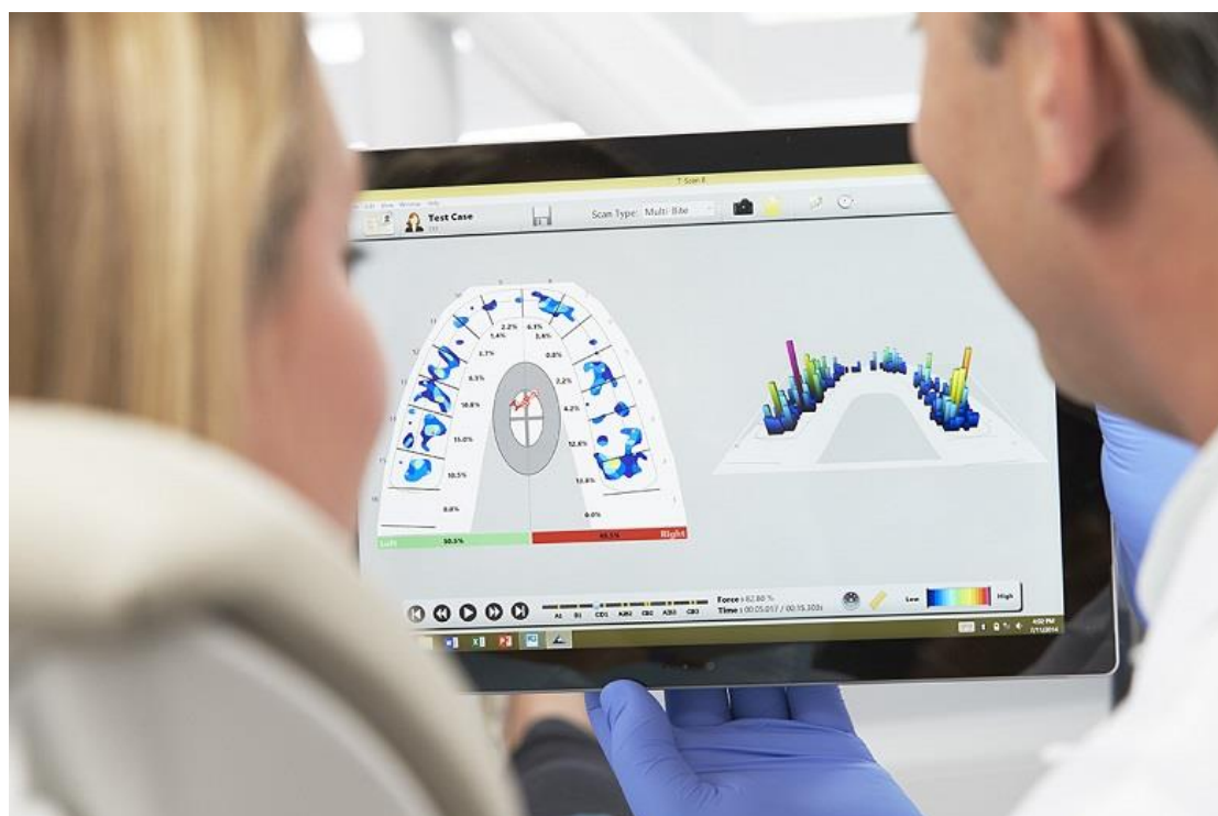
Σχήμα: 4.3.: Το T-Scan το σύστημα μέτρησης των οδοντικών μασητικών δυνάμεων.
