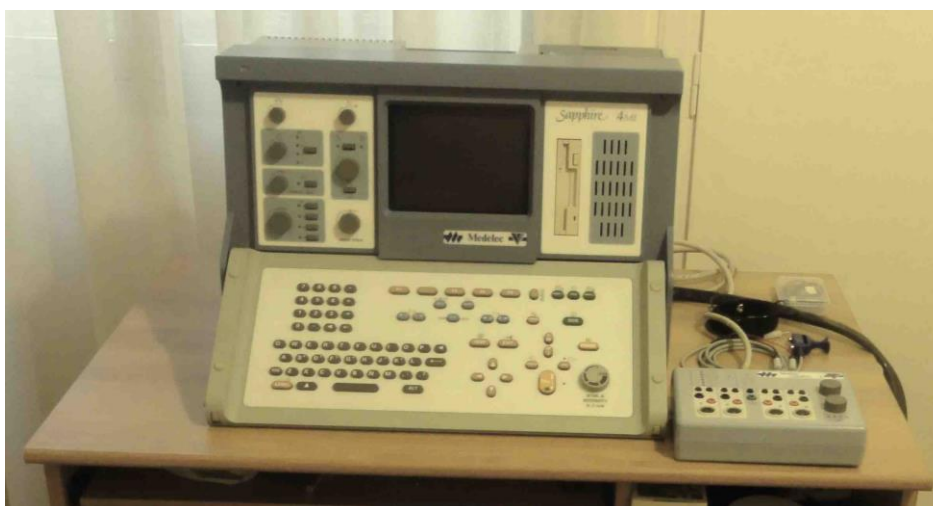
Σχήμα: 6.9.: Τυπική διάταξη για την καταγραφή του ΗΜΓ.
