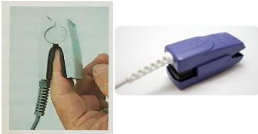
Σχήμα: 7.63.: Τυπικό δείγμα διάταξης φωτοπληθυσμογραφικού αισθητήρα.
