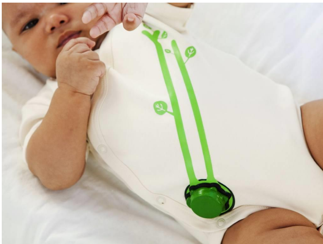
Σχήμα: 9.1.: Το φορμάκι «MIMO» για βρέφη ειδοποιεί τους γονείς για πιθανά συμπτώματα του συνδρόμου αιφνιδίου θανάτου, μέσω WiFi στο κινητό τους τηλέφωνο.
