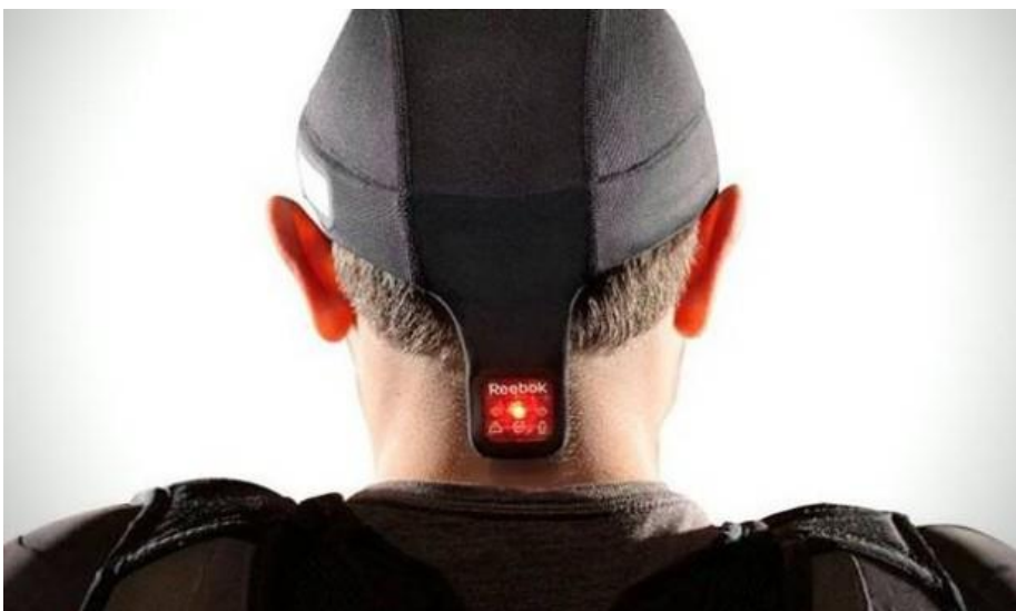
Σχήμα: 9.5.: Ο «έξυπνος» σκούφος καταγράφει στοιχεία σχετικά με τα χτυπήματα που δέχεται ο αθλητής στο κεφάλι καθιστώντας ευκολότερη η διάγνωση και αντιμετώπιση του κρανιακού τραύματος από τους ιατρούς.
