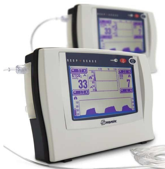
Σχήμα: 7.97.: Σύστημα καπνογραφίας RespSense για απλή και γρήγορη παρακολούθηση εκπνεόμενου EtCO 2 (μερικής πίεσης), ιδανικό για την εντατική ή το ασθενοφόρο.
