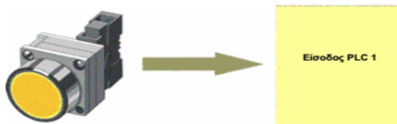
Εικόνα 1.17:Διάταξη λειτουργίας Μονάδας Εισόδου PLC
