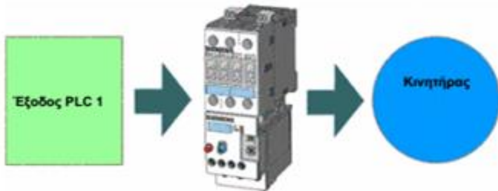
Εικόνα 1.18:Διάταξη λειτουργίας Μονάδας Εξόδου PLC
