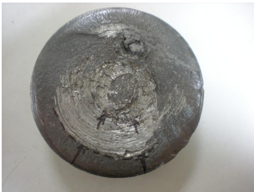
Εικόνα 41: Επιφάνεια θραύσης - μικροσκοπική ανάλυση
