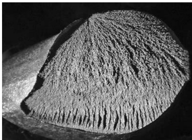
Εικόνα 19:Χαρακτηριστικά σημάδια chevron σε ψαθυρή θραύση(practical plant)
