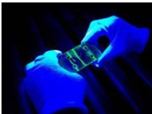
Εικόνα 27: Έλεγχος με φθορίζοντα διεισδυτικά υγρά (Fluorescent-Penetrant Inspection)
