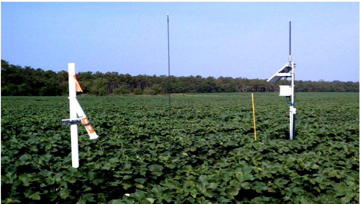
11) Σύστημα ασύρματων αισθητήρων υγρασίας εδάφους σε καλλιέργεια
