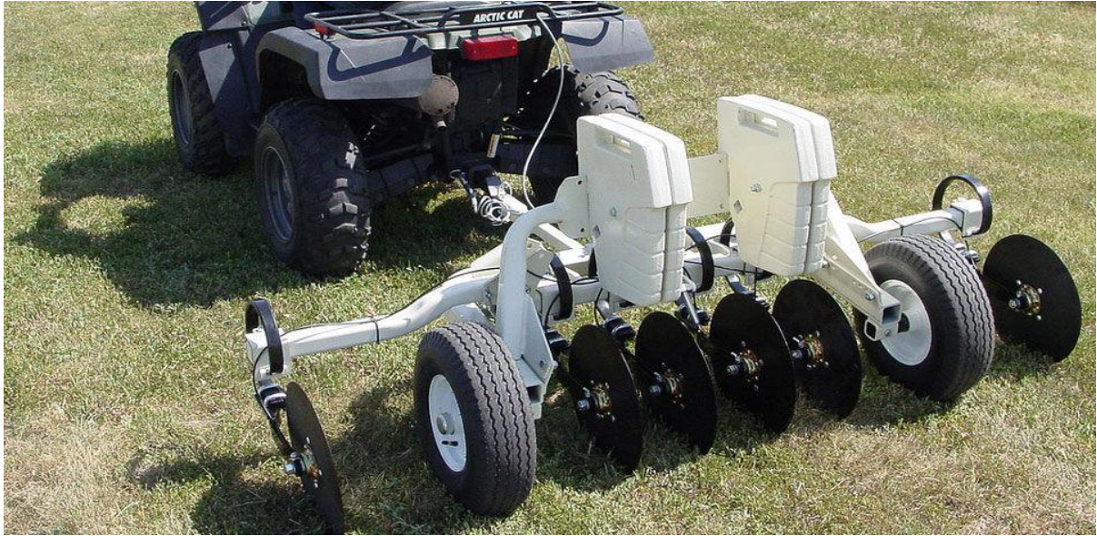
10) Σύστημα μέτρησης ηλεκτρικής αγωγιμότητας με επαφή (Veris Q2800)
