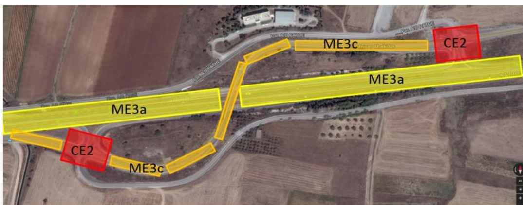
Σχήμα 127. Κατηγορίες φωτισμού σε ανισόπεδο κόμβο αυτοκινητοδρόμου
