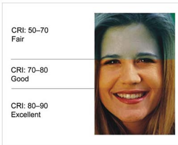
Σχήμα 81 . Παράδειγμα δείκτη χρωματικής απόδοσης
