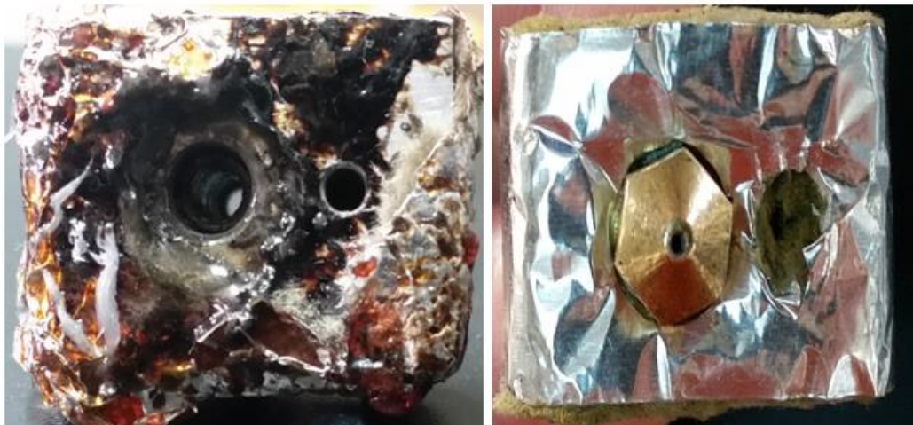
Εικόνα 7.2 - Πριν καθαριστεί η κεφαλή και μετά την συντήρησή της
