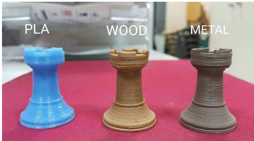
Εικόνα 5.6 - Σύγκριση αντικειμένων με χρήση διαφορετικών υλικών
