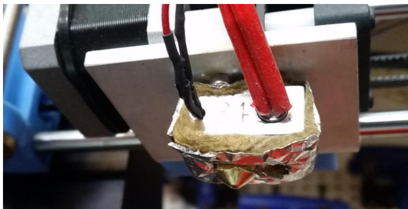
Εικόνα 7.7 - Επανατοποθέτηση συντηρημένης κεφαλής
