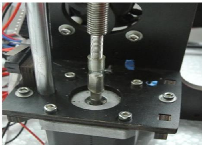
Εικόνα 2.17 - Σύνδεση αξόνων με τον βηματικό κινητήρα
