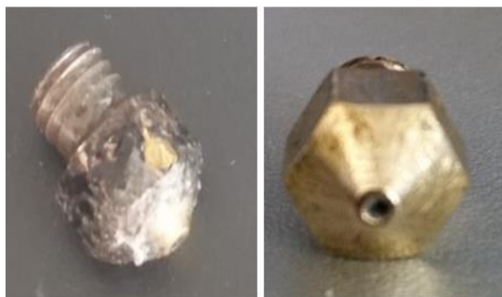
Εικόνα 7.3 - Η μύτη της κεφαλής πριν την συντήρηση
