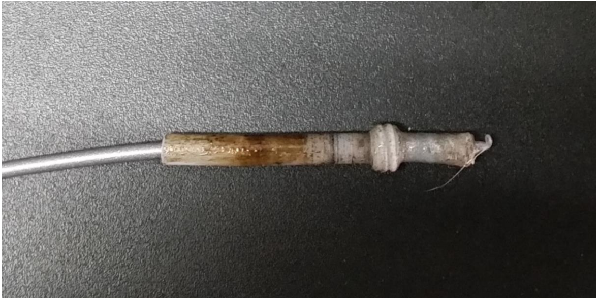
Εικόνα 6.1 - Κατεστραμμένο σωληνάκι σιλικόνης από έκχυση μεγάλης ποσότητας υλικού
