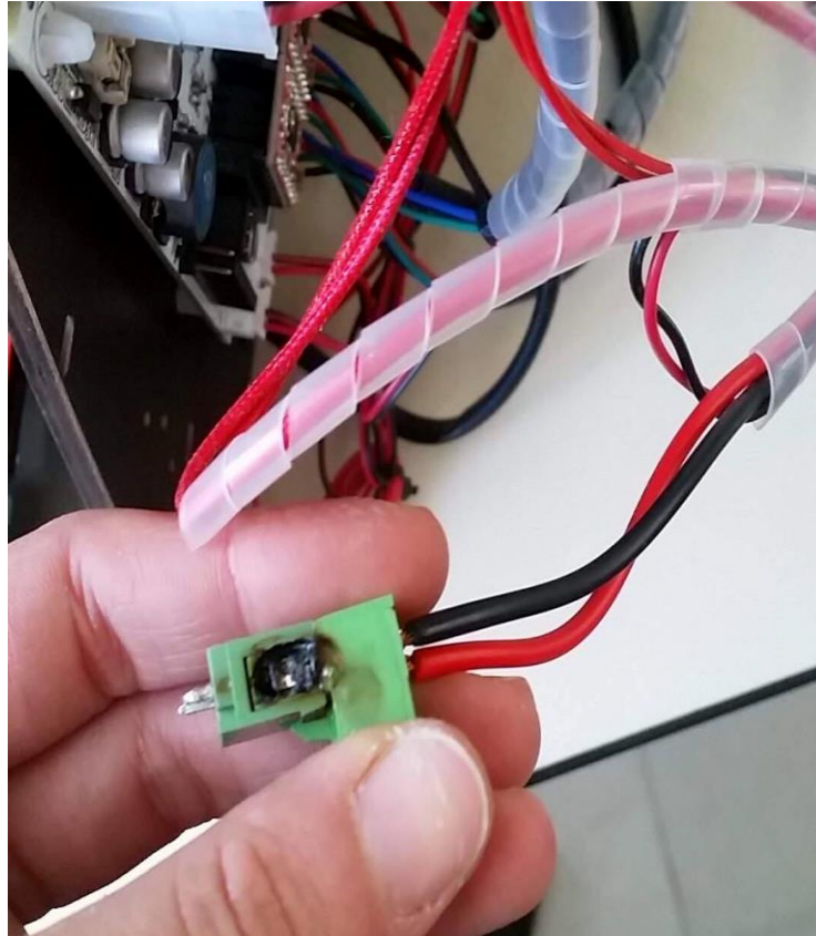
Εικόνα 6.3 - Καμένο φινι πλακέτας
