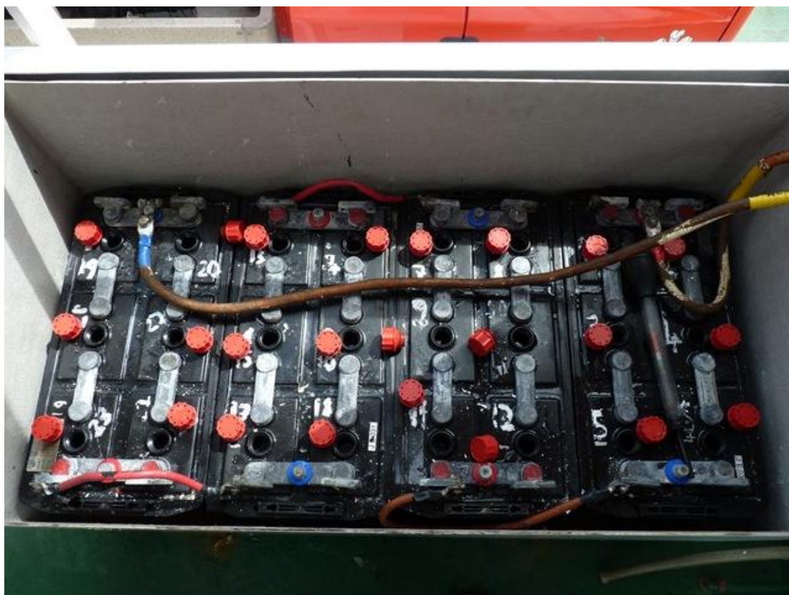
Εικόνα 10. Τμήμα του συσσωρευτή ανάγκης των πλοίων
