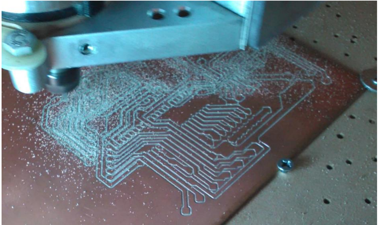
Εικόνα 24. Διαδικασία κατασκευής της πλακέτας
