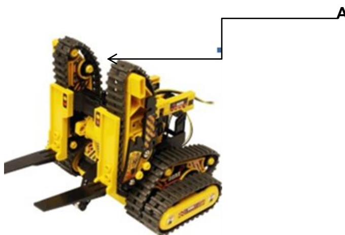
Εικόνα 7.3 Το ανυψωτικό όχημα με το σημείο τοποθέτησης της βάσης
