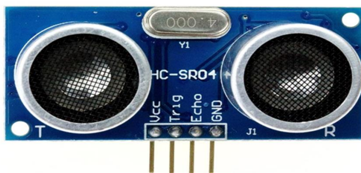
Εικόνα 6.6 Αισθητήριο υπερήχων HC-SR04 (διακρίνονται οι 4 ακροδέκτες)
