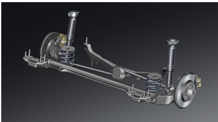
Εικόνα 8: δομή συστήματος ανάρτησης με ημιάκαμπτο άξονα
