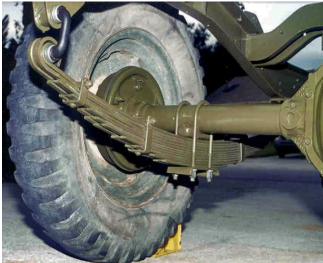
Εικόνα 2: Ημιελλειπτικό ελατήριο αμαξώματος
