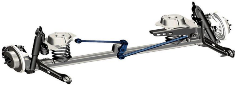
Εικόνα 7: δομή συστήματος ανάρτησης με άκαμπτο άξονα
