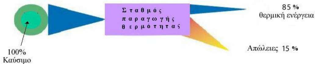
Σχήμα 2. Συμβατικός τρόπος παραγωγής θερμότητας
