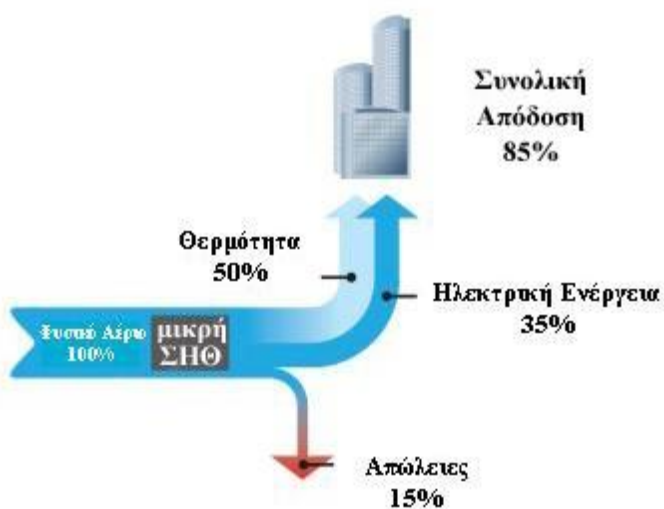
Σχήμα 3. βαθμός απόδοσης συστήματος ΣΗΘ
