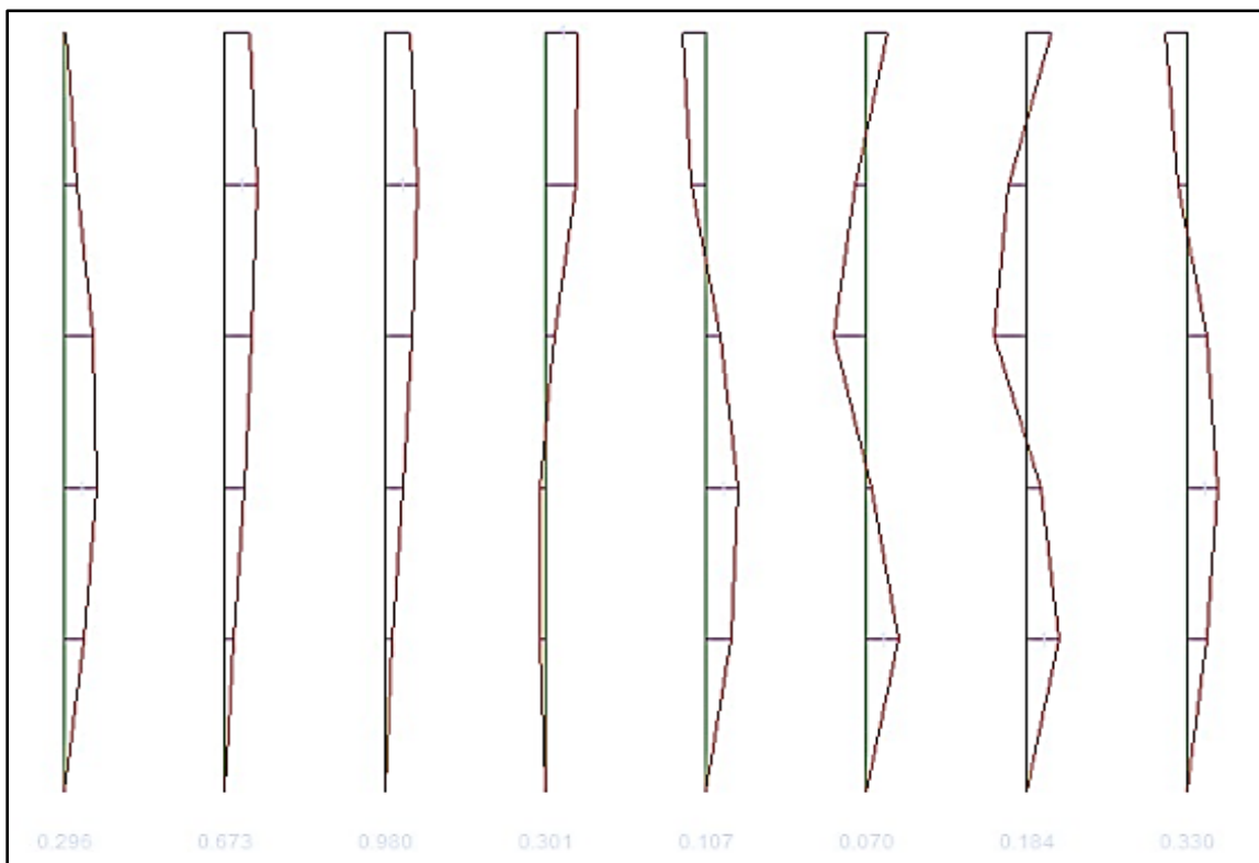
Ιδιομορφές κατά τη διεύθυνση x
