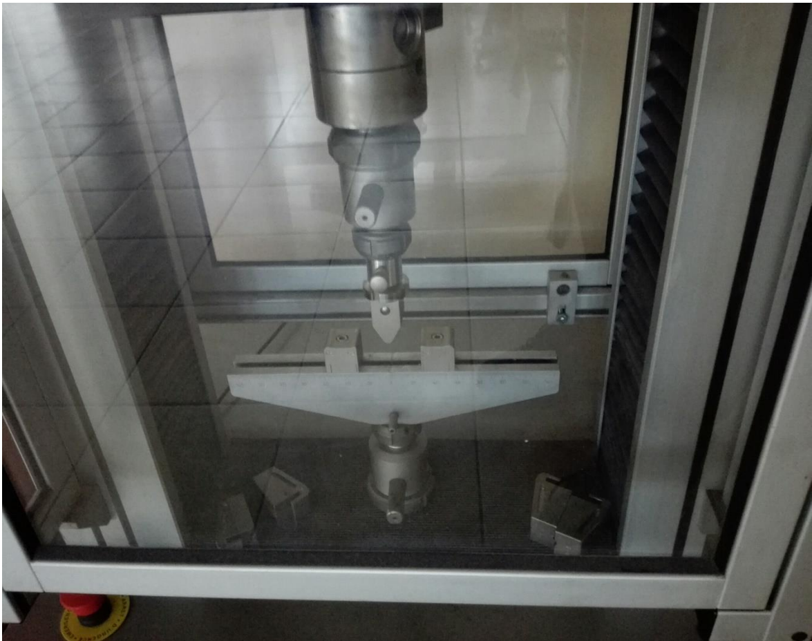
Εικόνα 14: Πειραματική διάταξη για αντοχή σε κάμψη του εργαστηρίου μηχανικής.
