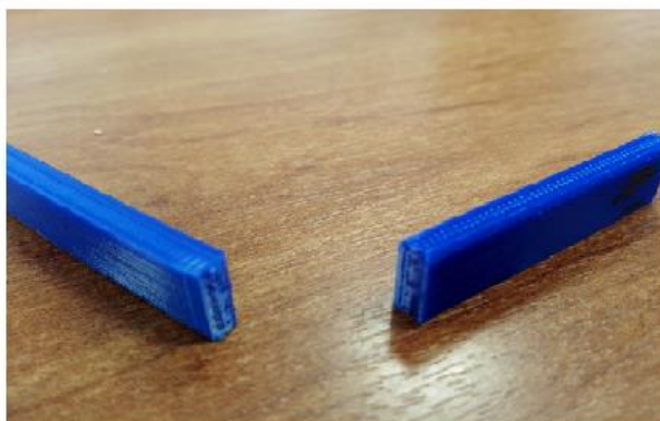
Εικόνα 20: Δοκίμιο petg υπό κάμψη. Τα δοκίμια από petg υλικό παρουσίασαν υψηλή αντοχή και μεγάλη δυσθραυστότητα και στις δύο περιπτώσεις (για v=2\text{mm/min} και v=4\text{mm/min} ).
