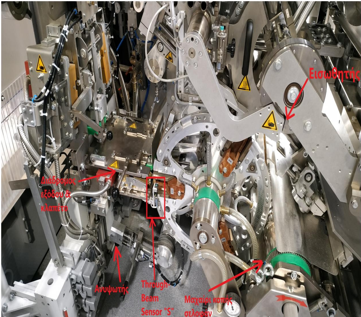
Εικόνα 7.2.5: 2 ος μύλος, διάδρομος εξόδου, μαχαίρι κοπής σελοφάν
