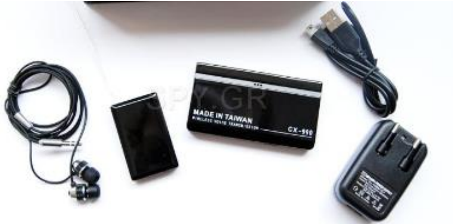
Εικόνα 6.25: Ασύρματο σύστημα ηχητικής παρακολούθησης (Πηγή: https://spy.gr/siskeves-parakolutisis-horu/852 )
