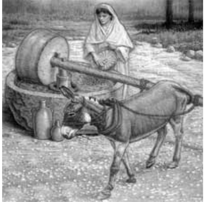
Εικόνα1. Κυκλικός μύλος βασισμένος στη ζωική δύναμη.
