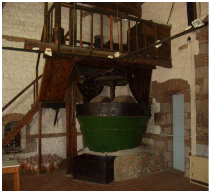
Εικόνα37. Ατμοκίνητος μύλος (μετά από συντήρηση) στο Κοινοτικό ελαιοτριβείο Μανταμάδου, Λέσβου.
