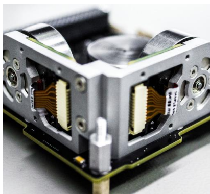
Εικόνα 28 : Σύστημα προσδιορισμού & ελέγχου θέσης, ακρίβειας μεγαλύτερης από 0,5° (Clyde Space)
