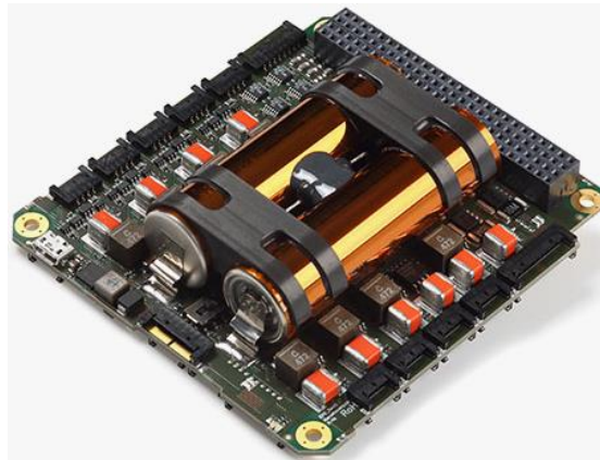
Εικόνα 24 : 3 rd Generation 1U (για δορυφόρο 1U, αριστερά) και 3 rd Generation FlexU (με εγκατεστημένη μπαταρία για δορυφόρο 3U, αριστερά) (ISIS)
