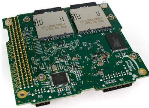
Εικόνα 60 : Υποσύστημα ελέγχου και διαχείρισης δεδομένων (ISIS)
