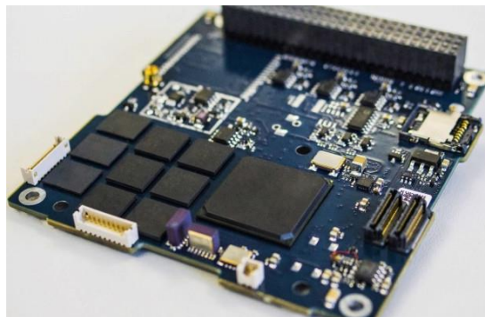
Εικόνα 61 : Υποσύστημα ελέγχου και διαχείρισης δεδομένων (CLYDE SPACE)
