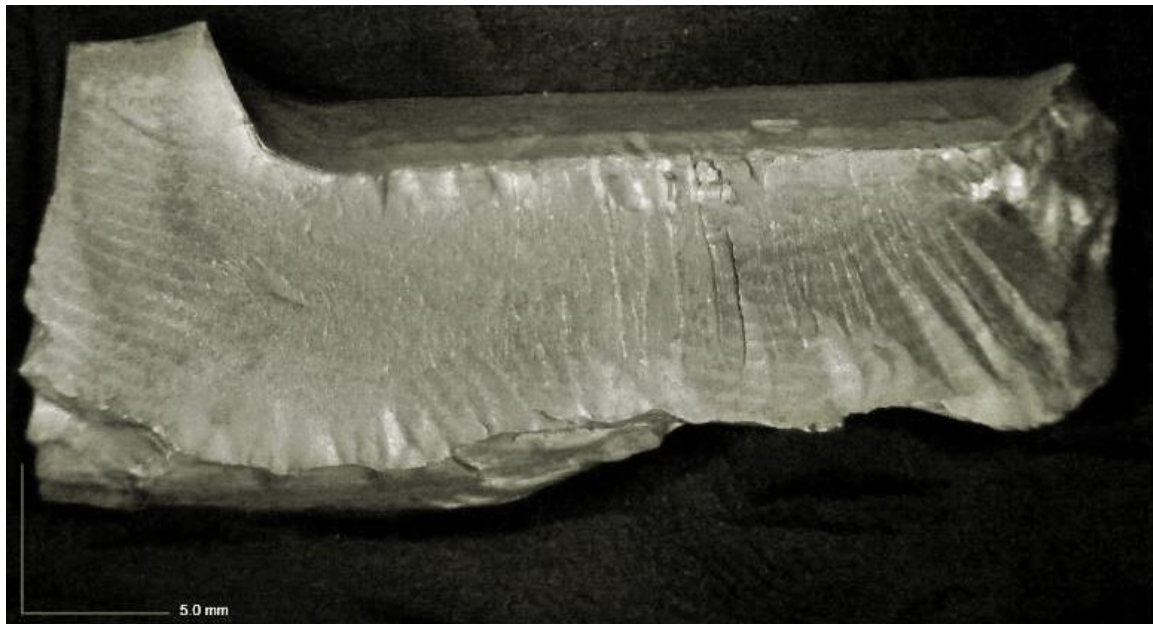
Εικόνα 4.26 Σημάδια κόπωσης στο θραύσμα, στο σημείο της σφήνας
