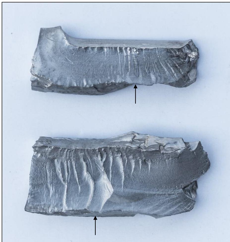
Εικόνα 4.10 Αποσαθρωμένη επιφάνεια θραύσματος και ίχνη από σημάδια παραλίας (βέλη) – άξονας N2.
