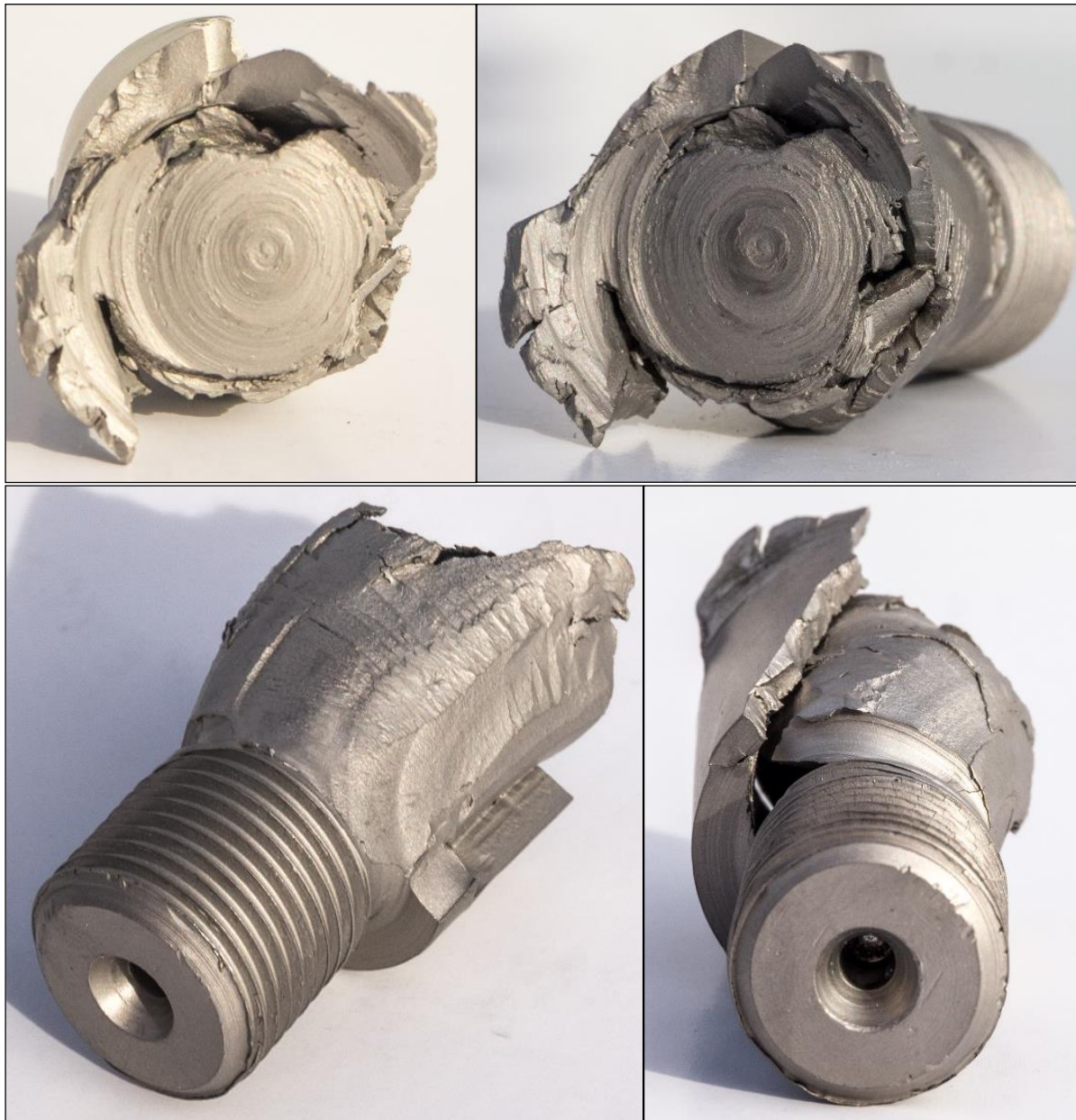
Εικόνα 4.16 Το κομμάτι του άξονα N1 που αποκολλήθηκε λόγω αστοχίας-Αποτελέσματα της αποσάθρωσης.
