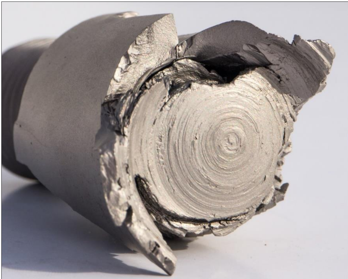
Εικόνα 4.9 Αποσαθρωμένη επιφάνεια θραύσματος από αντίθετη όψη – άξονας N1.
