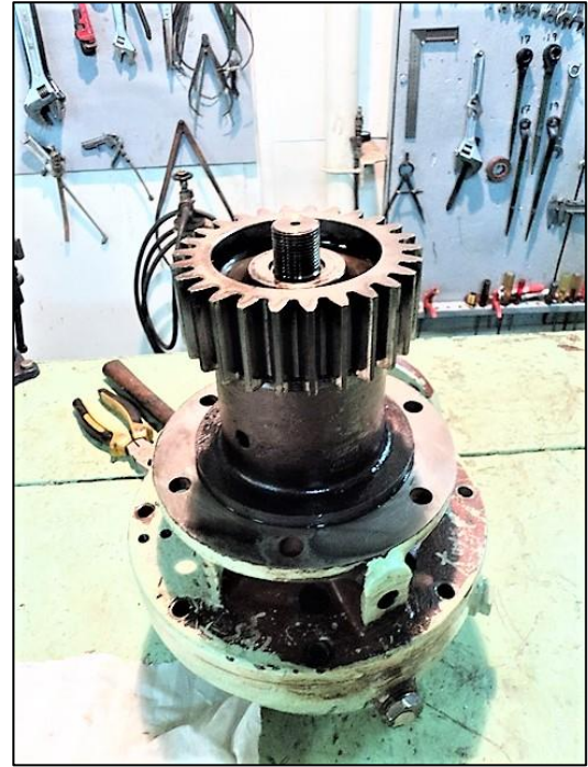
Εικόνα 4.3 Άξονας αντλίας μέσα στο κέλυφος (σώμα αντλίας).
