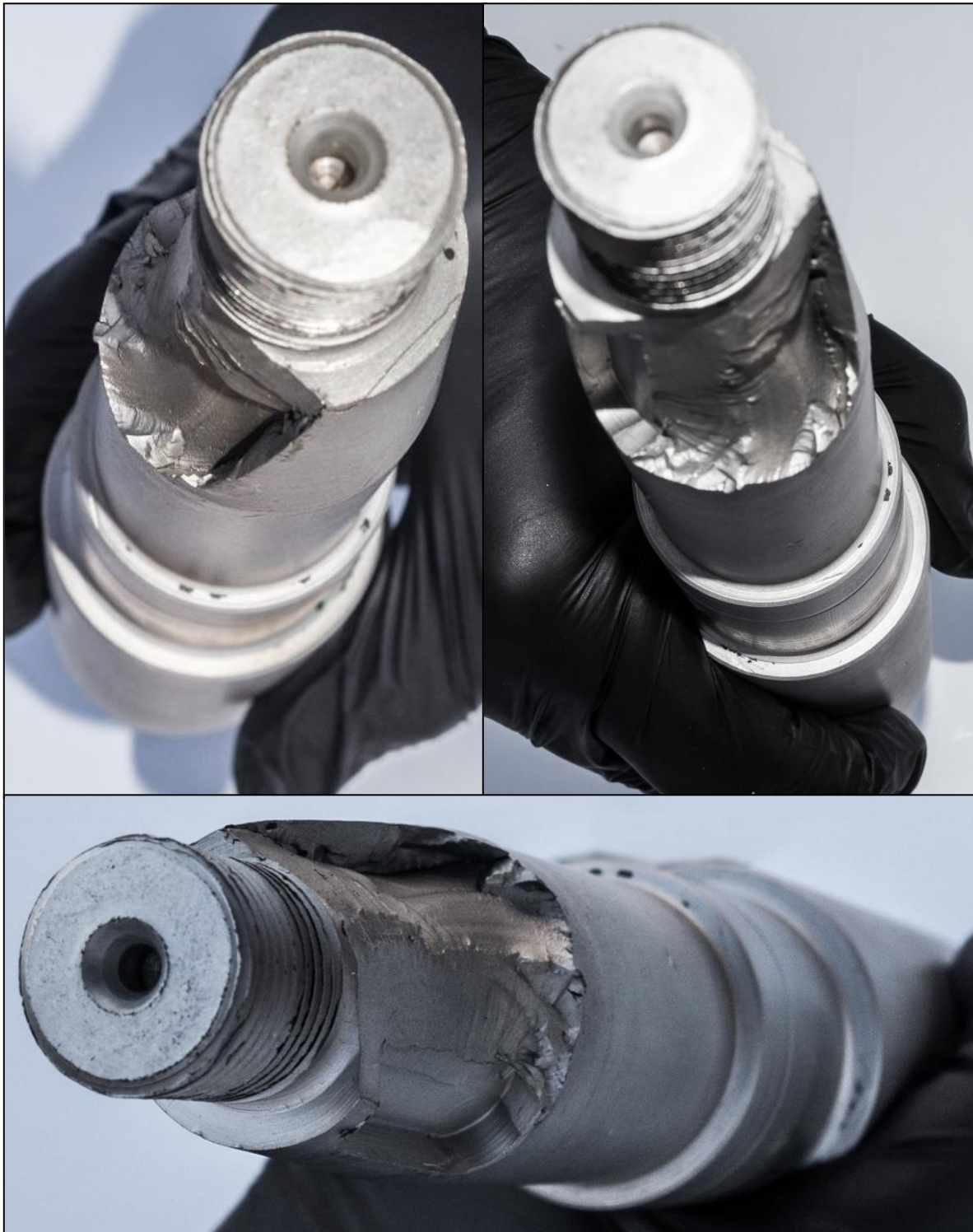
Εικόνα 4.18 Το σημείο θραύσης του άξονα και το σπείρωμα στο οποίο εφαρμόζει η περωτή, σε διαφορετικές οπτικές γωνίες.
