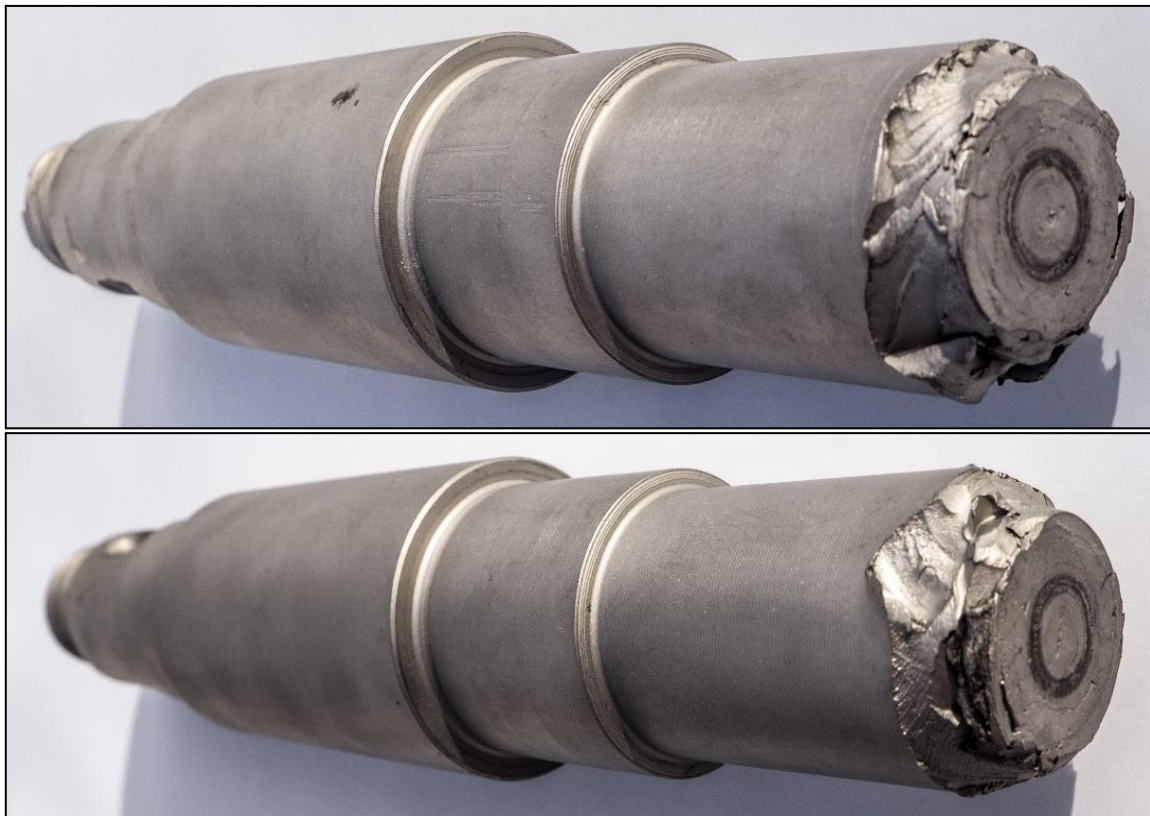
Εικόνα 4.13 Ο άξονας N1 σε πλήρη έκταση και το σημείο θραύσης του.
