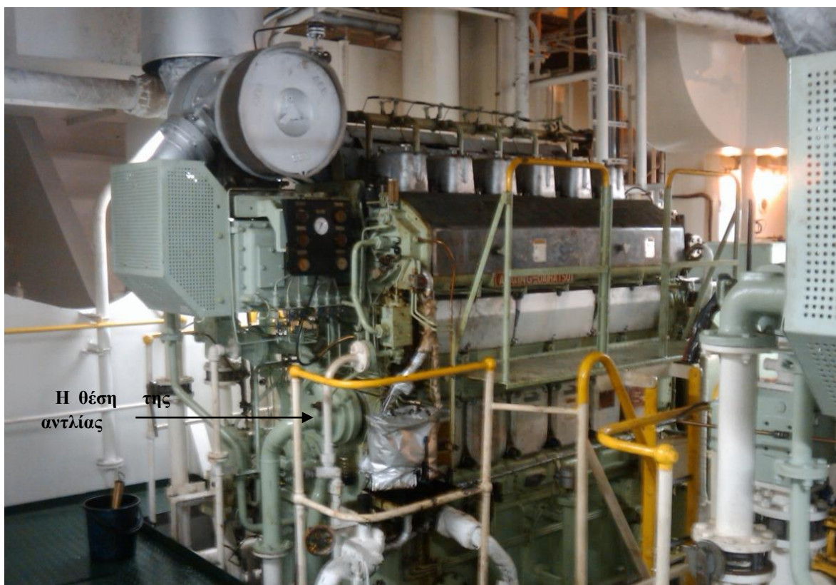
Εικόνα 4.1 Θέση αντλίας στον κινητήρα του πλοίου
