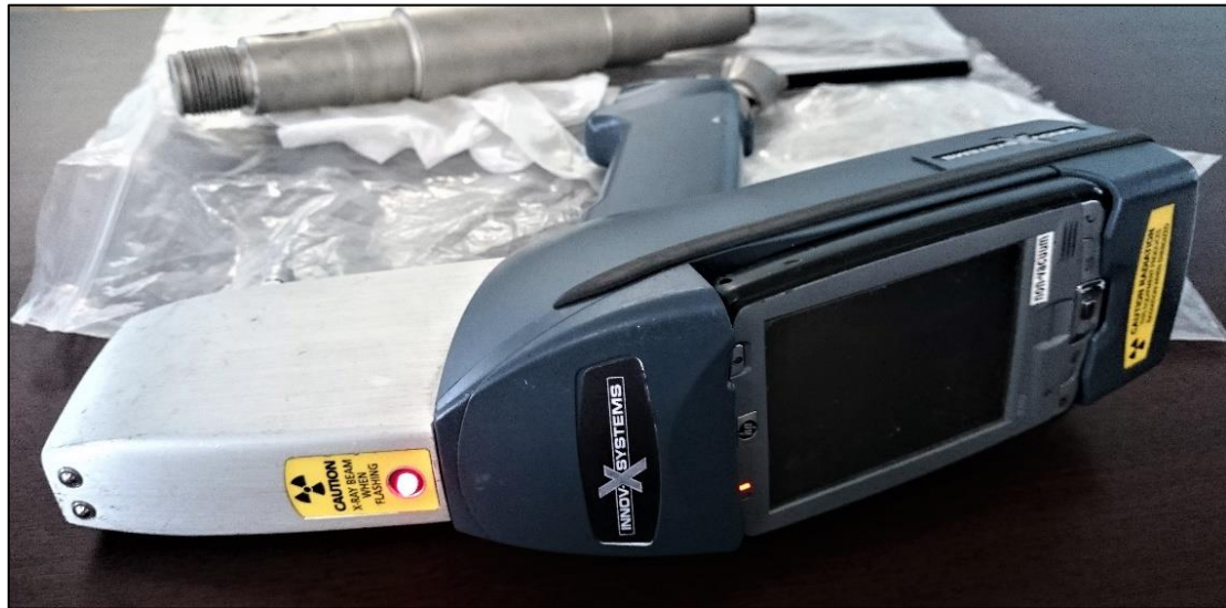
Εικόνα 4.34 Όργανο μέτρησης χημικής σύστασης υλικού το οποίο χρησιμοποιήθηκε.
