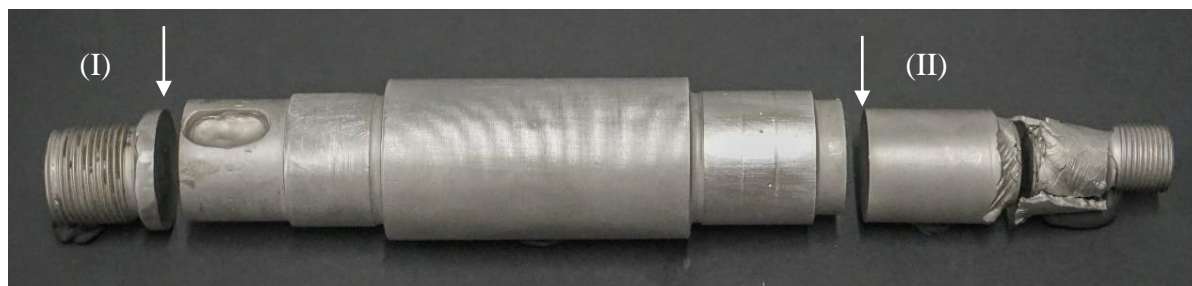
Εικόνα 5.3 Τα σημεία κοπής του άξονα N1 και οι επιφάνειες χημικής προσβολής.
