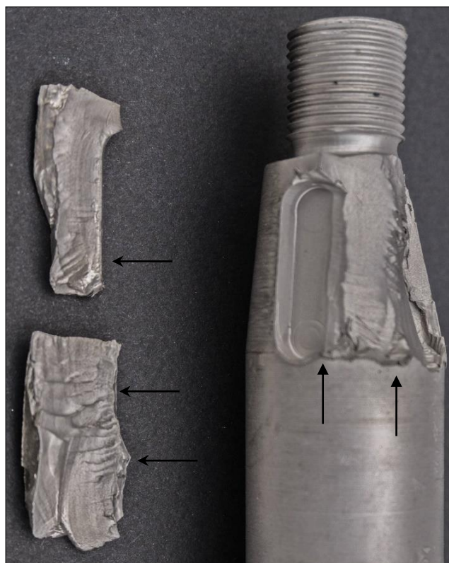
Εικόνα 4.7 Επιφάνειες θραύσης του άξονα N2 με την εμφάνιση γραμμών οι οποίες αντιστοιχούν σε στρεπτική καταπόνηση.
