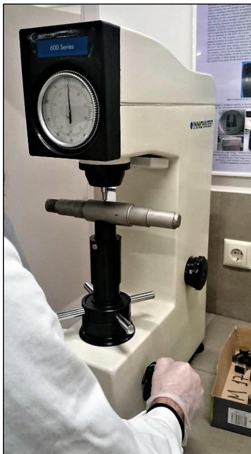
Εικόνα 4.31 Διαδικασία λήψης μετρήσεων σκληρότητας του άξονα.
