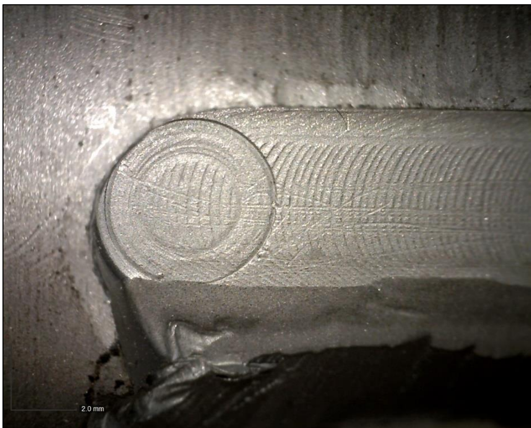
Εικόνα 4.30 Εσωτερικό σφηνάλακας με διακριτά τα σημάδια φρέζας.
