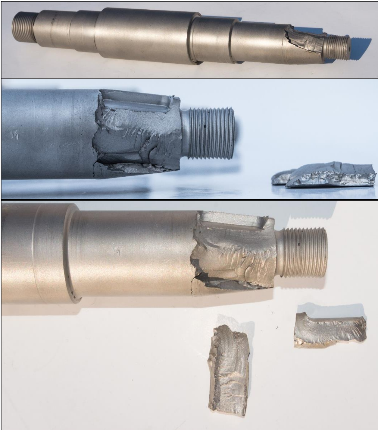
Εικόνα 4.17 Ο άξονας σε πλήρη έκταση με τα θραύσματά του και εστιασμένο σημείο θραύσης
