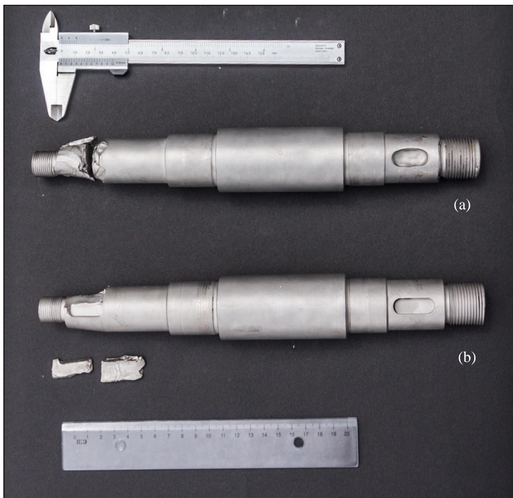
Εικόνα 4.5 Γενική άποψη των δύο αστοχούντων αξόνων μαζί με τα θραύσματά τους.
