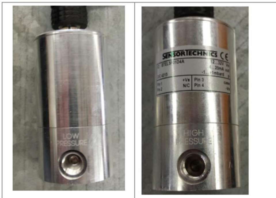
Σχήμα 5.4 θ Αισθητήρας διαφορικής πίεσης μηχανοστασίου (θύρες μέτρησης High και Low)
