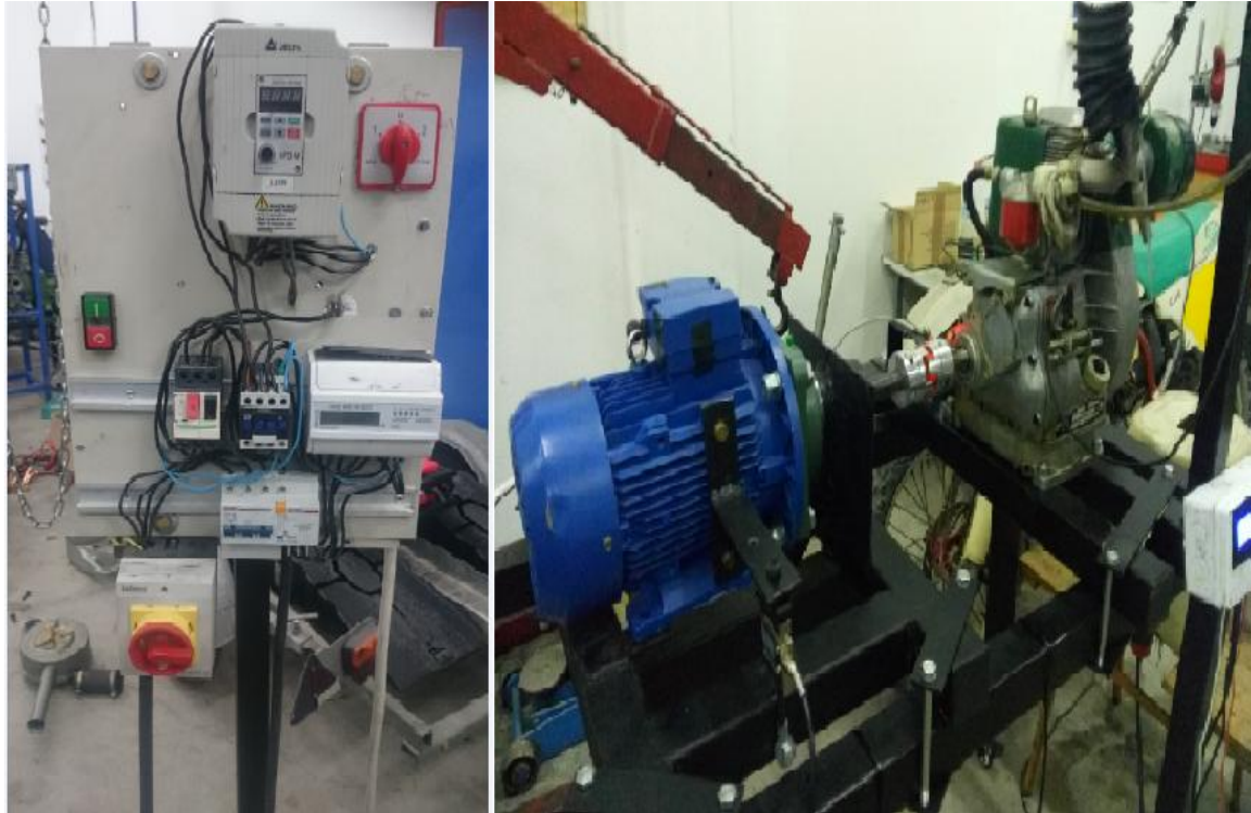
Εικόνα 3.2.4: Τελική κατασκευή δυναμοπέδης
