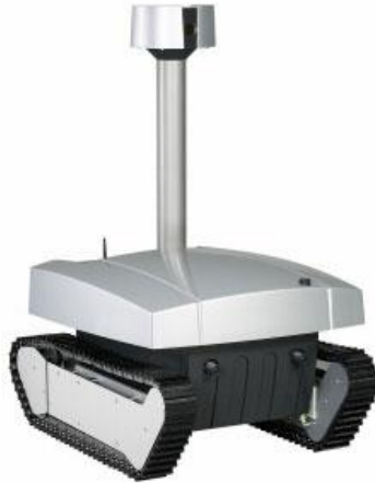
Εικόνα 1.2 Το ρομπότ επιτήρησης OFRO της Robowatch.
