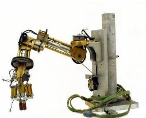
Εικόνα 1.10 Το Rancho Arm, ένας από τους πρώτους τεχνητούς βραχιόνες ελεγχόμενος από υπολογιστή.
