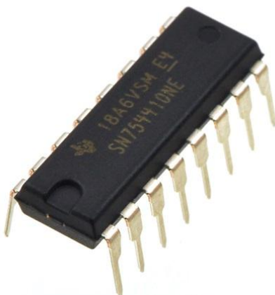
Εικόνα 8.4 Ο μικροελεγκτής SN754410 H-Bridge
