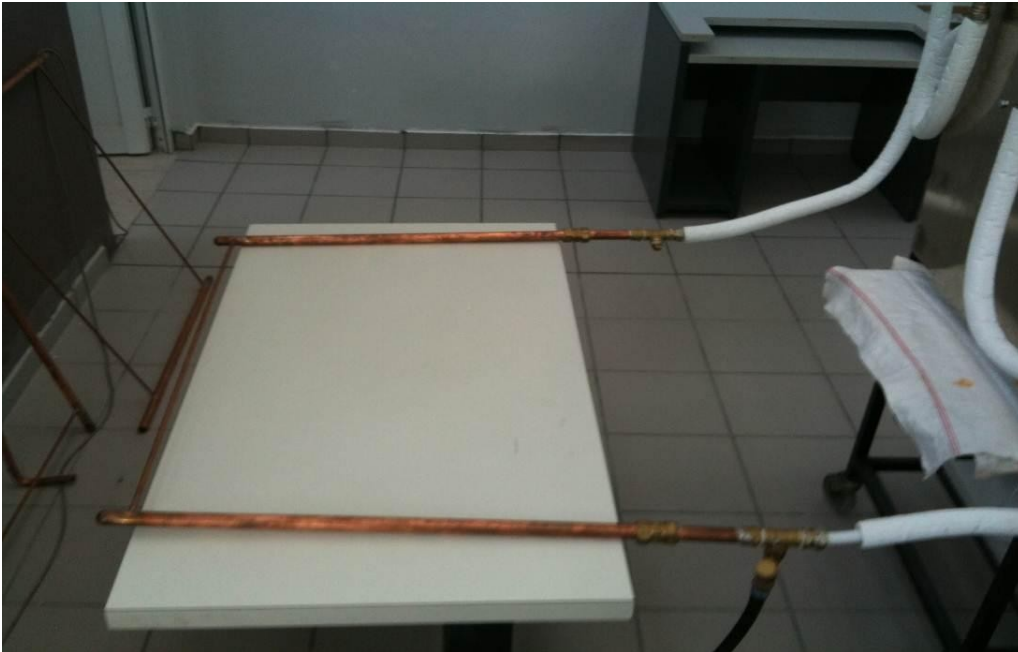
Σχήμα 2.16: Δοκιμαστική σωλήνα μικρότερου μήκους πάνω στη εγκατάσταση.
