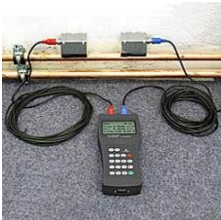
Εικόνα 2.5: Μετρητής ροής με υπερήχους (συγκεκριμένα, για ομογενή υγρά)
