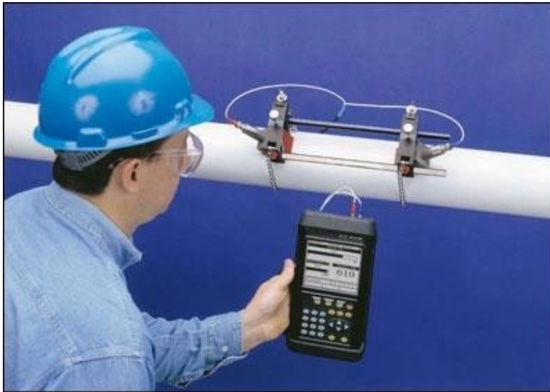
Σχήμα 2.6: Τυπική μορφή ροόμετρου με την μέθοδο υπερήχων
