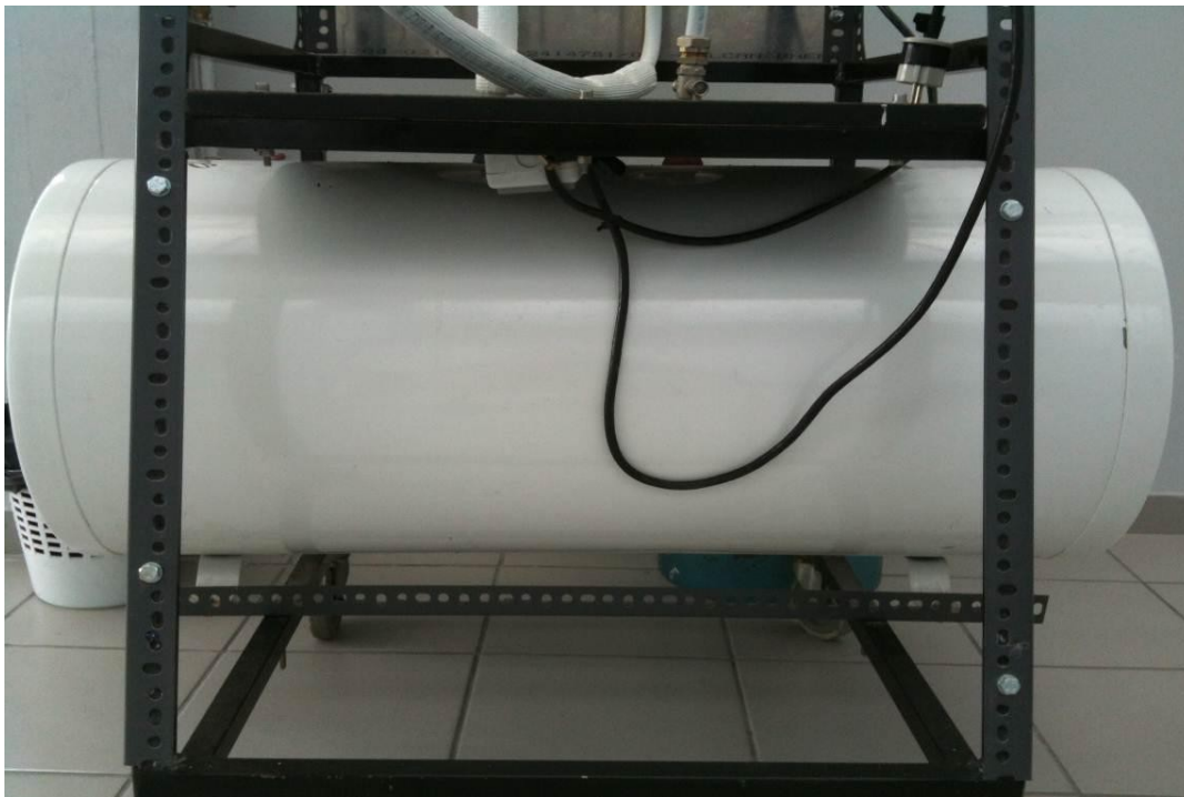
Σχήμα 2.8: Δεξαμενή νερού ή αλλιώς θερμοσίφωνα πίεσης.
