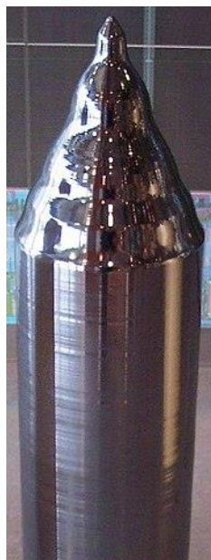
Σχήμα 6.1.1.1: Καθαρό μονοκρυσταλλικό πυρίτιο ανεπτυγμένο με τη μέθοδο Czochralski.
