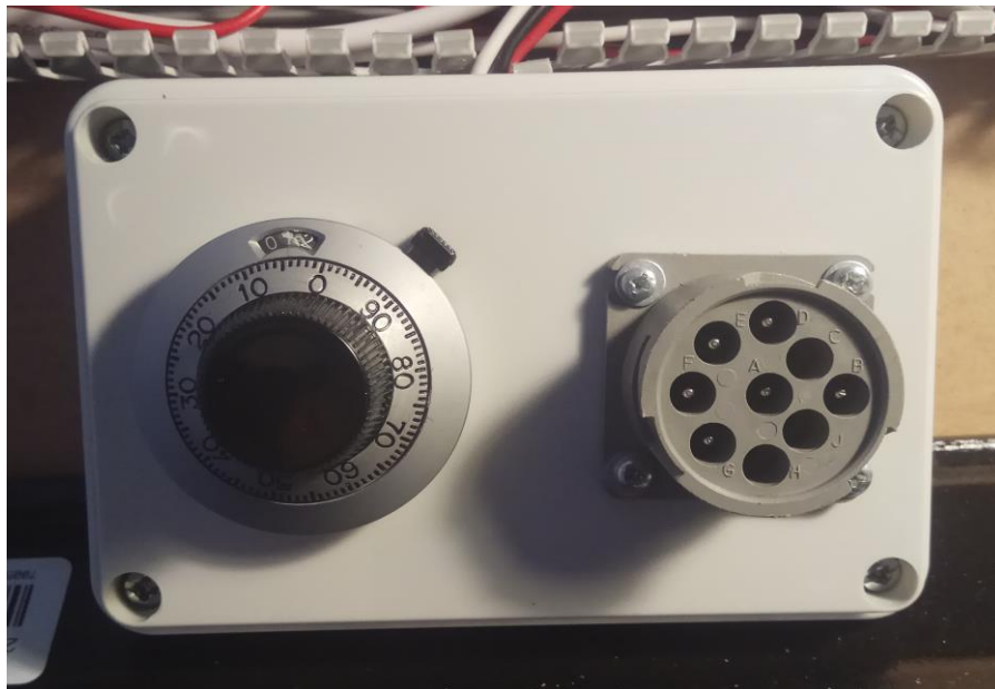
Εικόνα 27 Περιστροφικός επιλογέας σήματος επιθυμητών στροφών
