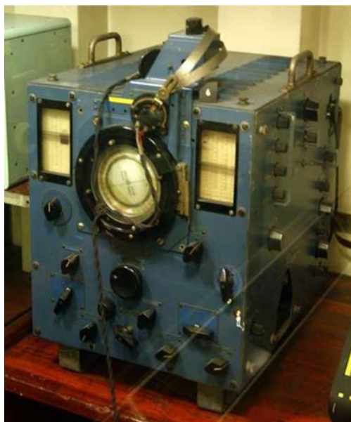
Εικόνα 9: Ραδιογωνιόμετρο με σταθερές κεραίες
