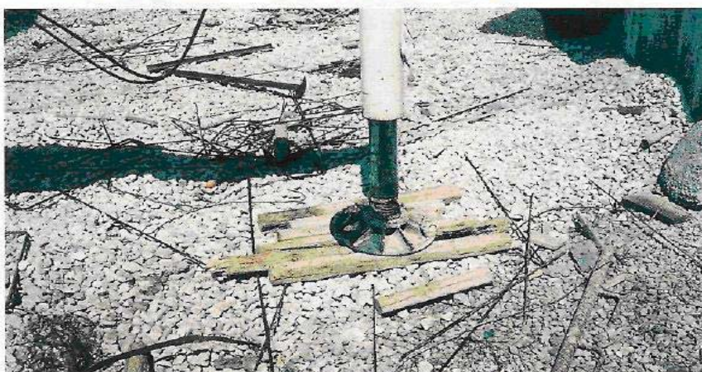
Λανθασμένη έδραση ποδαρικού. Κίνδυνος ανατροπής της αντλίας. Απαιτείται έδραση σε τάκους, αφού καθαριστεί το έδαφος
