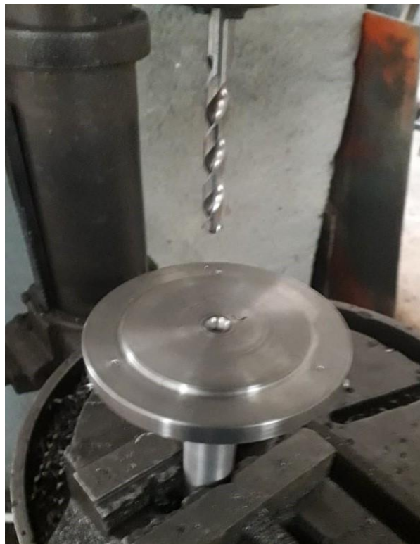
Σχήμα 2.9. Διάνοιξη οπών με δρέπανο.
