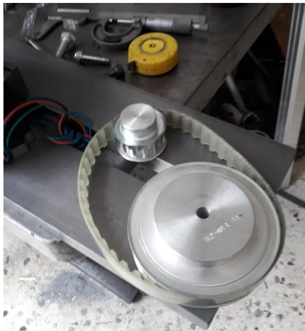
Σχήμα 2.13. Τροχαλίες και βηματικός ιμάντας.
