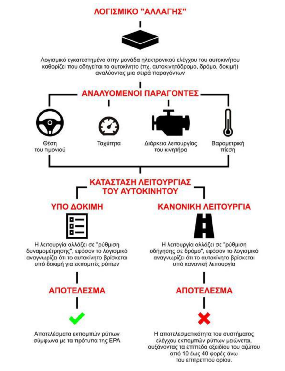
Εικόνα 4.1: Τρόπος λειτουργίας συσκευής VW (ΙΔΕΕΑ, 2015)
