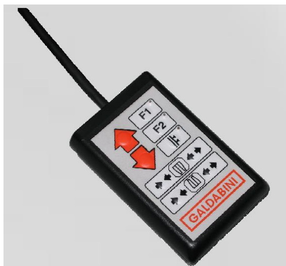
Σχήμα 11- 2: Τηλεχειριστήριο μετακίνησης της κεφαλής πριν την εκκίνηση και μετά την περάτωση της δοκιμής
