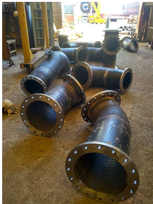
Εικόνα 105: Σωληνώσεις αμέσως μετά την συγκόλληση “TIG”.
