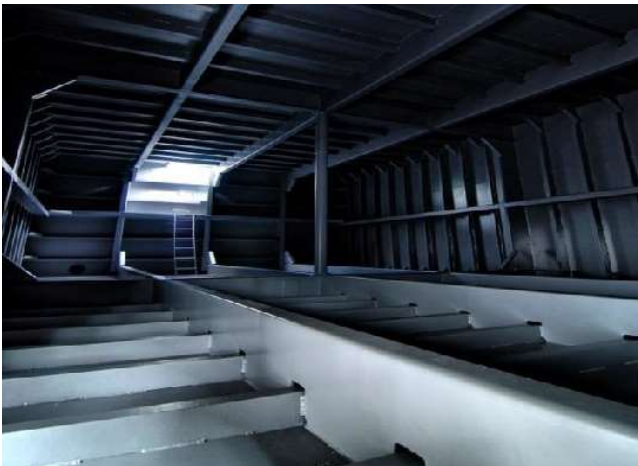
Εικόνα 47: Φωτογραφίες δεξαμενής έρματος όπου φαίνονται τα ανοίγματα και τα κανάλια που διαθέτουν.
