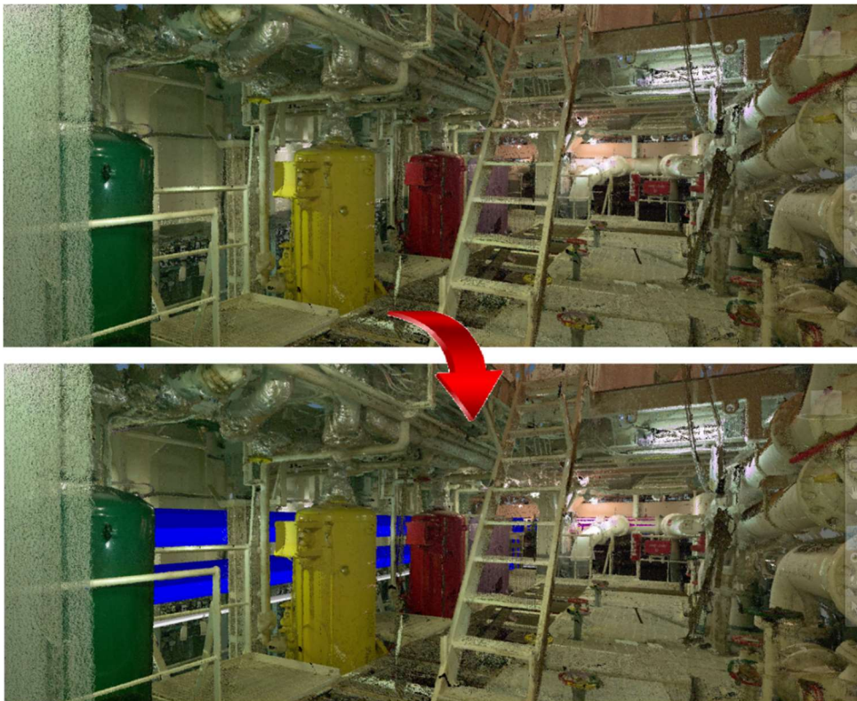
Εικόνα 86: “3D” σχέδια σωληνώσεων εντός τους νέφους.
