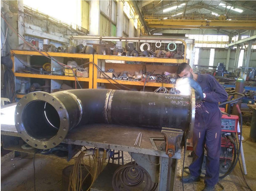
Εικόνα 106: Ηλεκτροσυγκόλληση σωλήνας με προσωπική εργασία.
