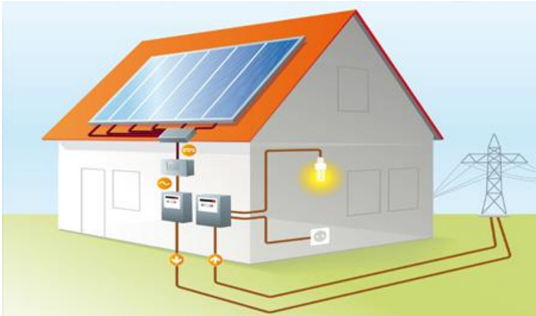
Εικόνα 33: Διασυνδεδεμένο υβριδικό σύστημα (Net metering).
