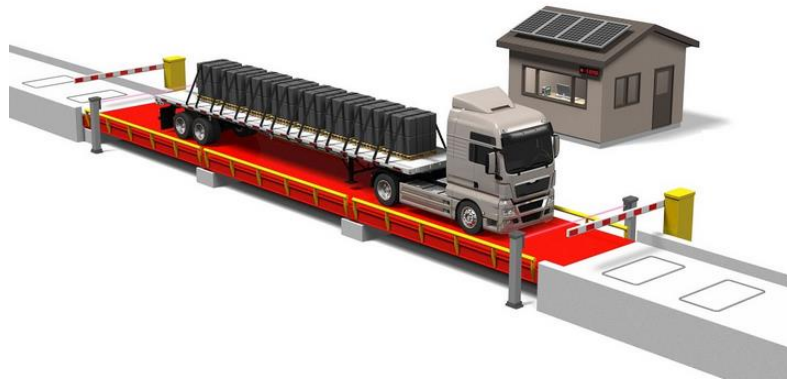
Εικόνα 2.26 Σχέδιο φορτηγού πάνω σε γεφυροπλάστιγγα, τυπική δομή εγκατάστασης ζυγιστικού συστήματος
