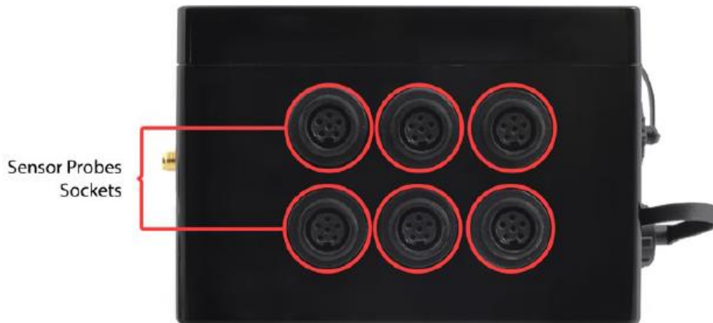
Εικόνα 4.2: Εμπρός μέρος κεντρικού οργάνου με υποδοχείς για αισθητήρες.
