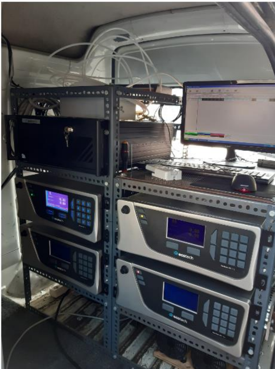
Εικόνα 3.2: Η διάταξη εντός του βαν με τους αναλυτές και τον ηλεκτρονικός υπολογιστής.
