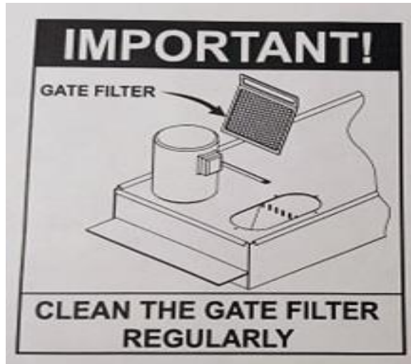
Εικόνα 10. Καθαρισμός και θέση φίλτρου πλέγματος δεξαμενής ψυκτικού υγρού. Πηγή HAAS VF SERIES Operator's Manual January 2003
