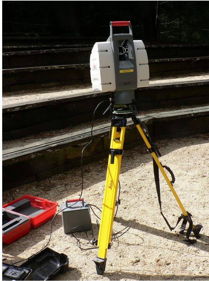
Εικόνα 2: Αυτός ο σαρωτής lidar μπορεί να χρησιμοποιηθεί για τη σάρωση κτιρίων, σχηματισμών βράχου κλπ.
